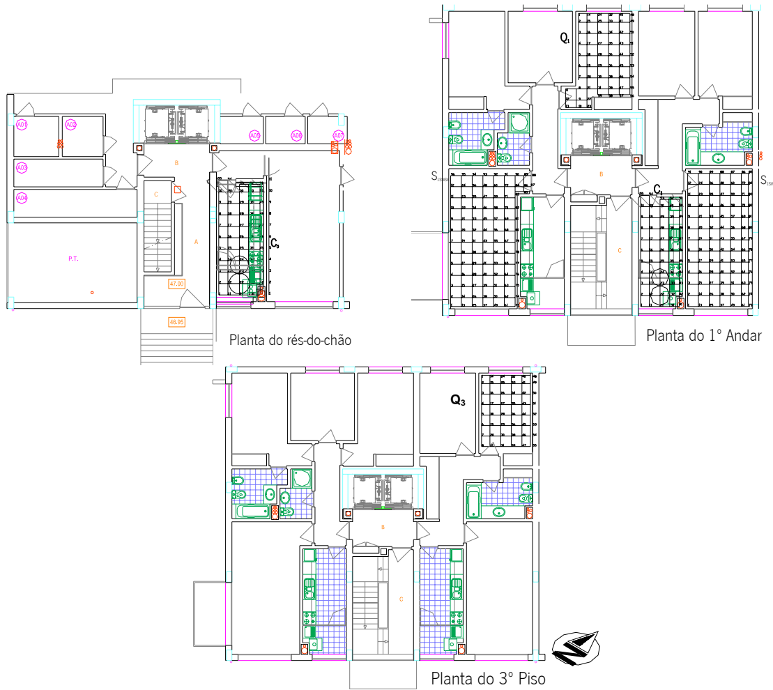
Figura 5.51 - Localização dos pontos de medição no compartimentos onde o FLD foi avaliado
