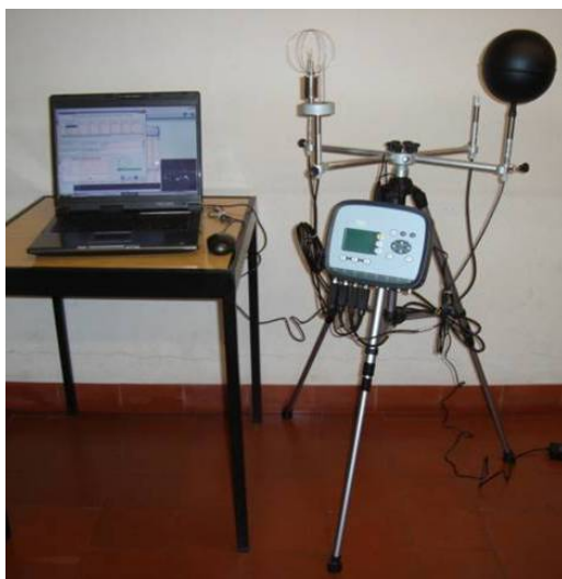
Figura I.15 – Estação de conforto
