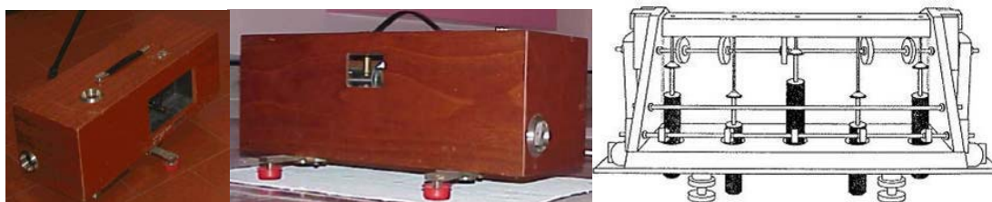
Figura I.32 – Fotografia e ilustração de uma máquina de percussão normalizada, modelo 3204 da Bruel & Kjaer (Hamayon 1996)
