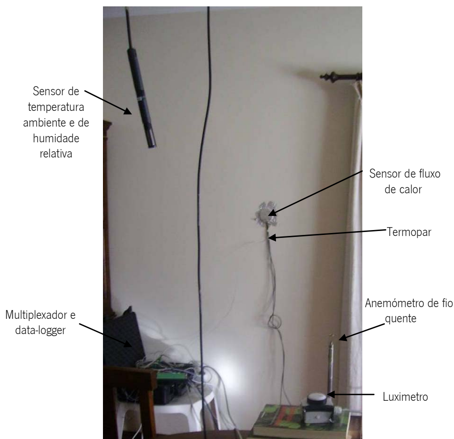
Figura I.14 – Equipamento de medição (sensor de fluxo de calor e de temperatura superficial interior, sensor de temperatura ambiente e humidade relativa, luxímetro e anemómetro de fio quente, velocidade do vento)
