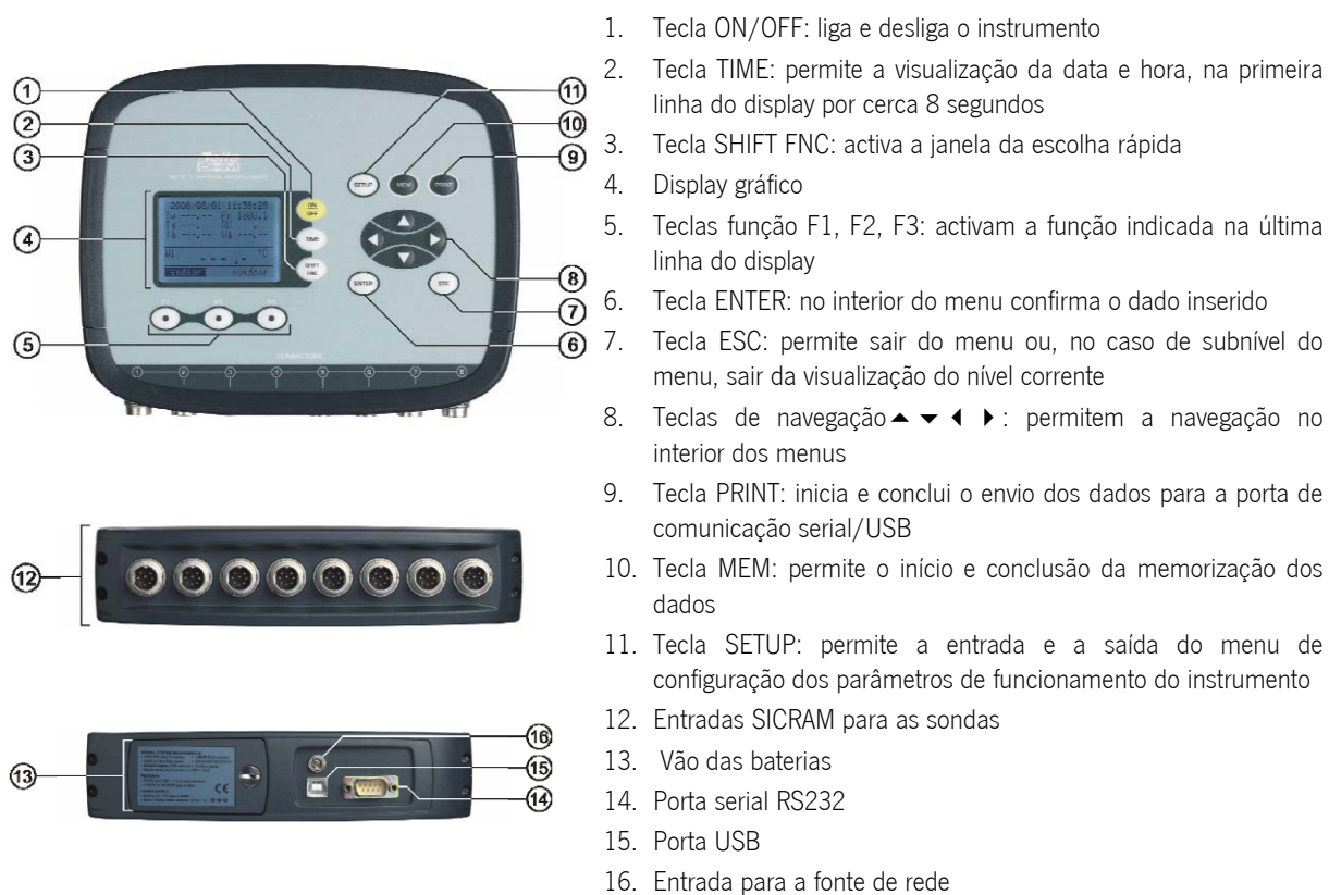
Figura I.16 – Pormenor do módulo de controlo, HD32.1, da estação de conforto
