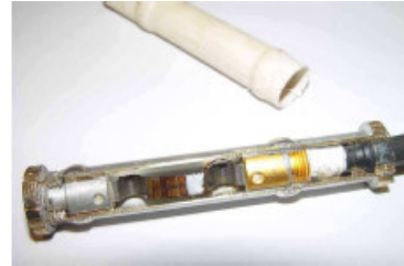
Fig. 2.43 – Extensómetros para medir deformações no betão (Carvalho e Gonçalves 2001)
