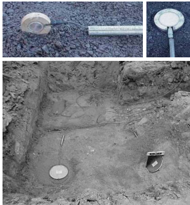
Fig. 2.48 – Aplicação de Células de Pressão (FiberSensing)
