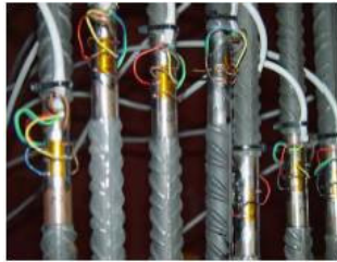
Fig. 2.42 – Extensómetros para medir deformações em armaduras (Carvalho e Gonçalves 2001)
