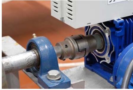
Figura 4.13 – Vista da união de veios.
