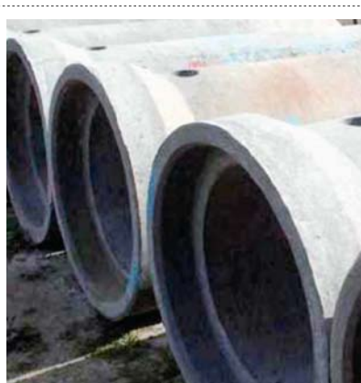
Fig. 4 – Manilhas para redes de águas residuais em betão geopolimérico com uma vida útil estimada de 900 anos [20]
