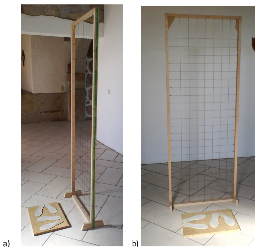
Figura 31: Posturógrafo com fita métrica: a) vista lateral com fita métrica; b) vista anterior com placa para posicionamento dos pés
