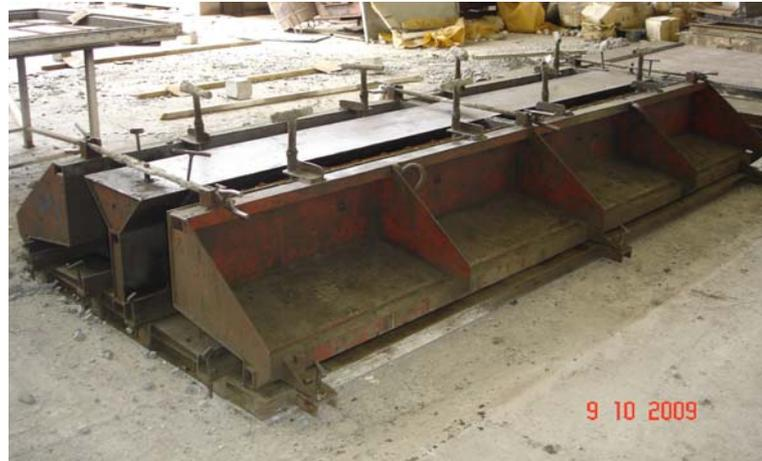
Figura 5.15 – Cofragem da peça a betonar
