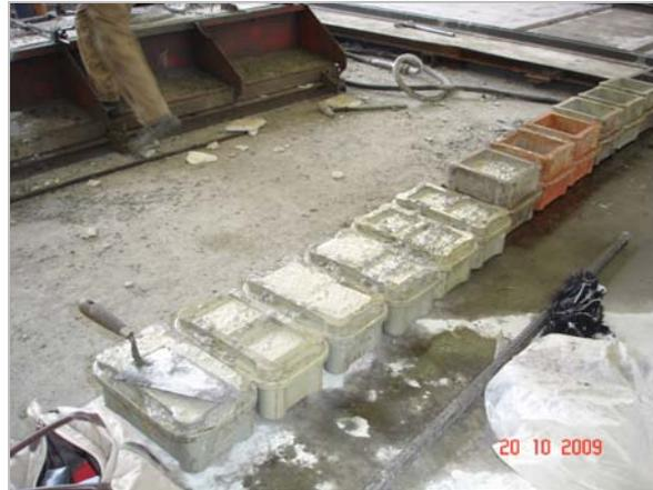
Figura 5.22 - Provetes da composição PAV 2
