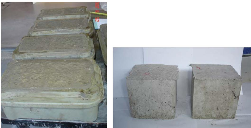
Figura 5.11 – Provetes da composição LAB 2 protegidos com película
