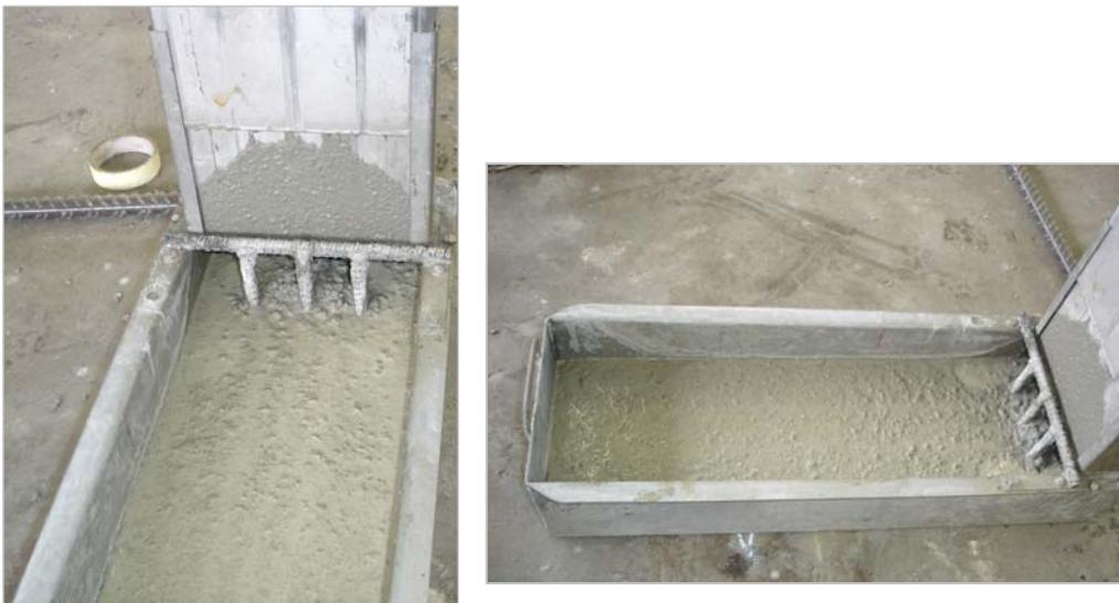
Figura 5.21 - Ensaio L-box 82 mm
