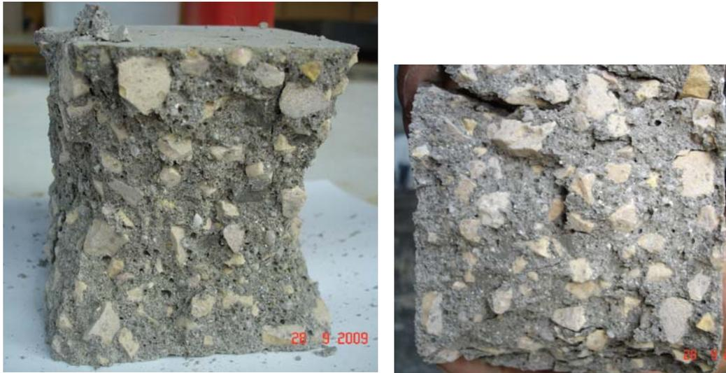
Figura 5.12 – Provete LAB 2 após o ensaio de resistência à compressão (3 dias)
