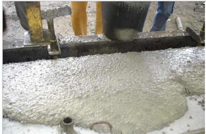
Figura 5.18 – Inspeção visual da composição PAV 1C
