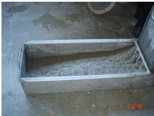
Figura 5.7 - Amostra LAB 1C Ensaio L-box (64 mm)
