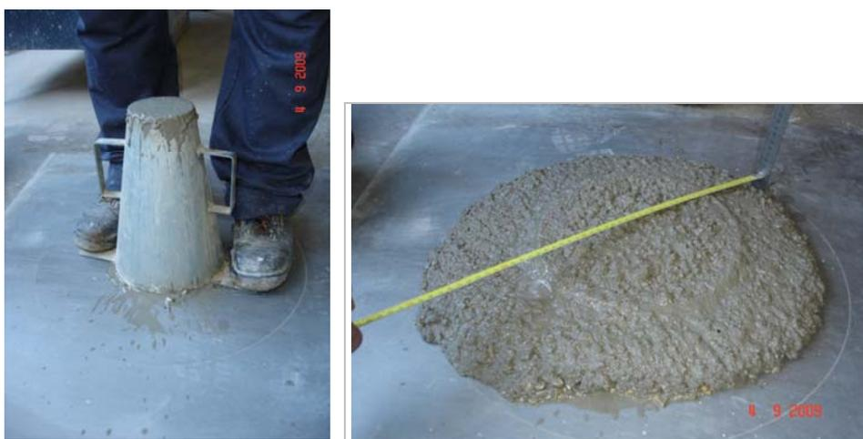
Figura 5.6 – Ensaio do Slump-flow ( 520 mm)
