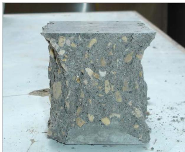
Figura 5.13 – Provete LAB 2 após o ensaio de resistência à compressão (14 dias)
