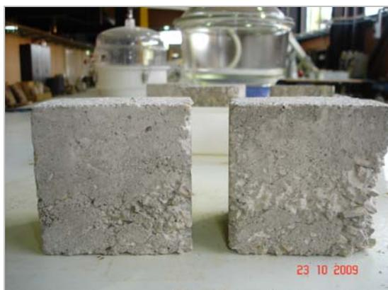
Figura 5.8 - Amostra LAB 1C (segregação visível)
