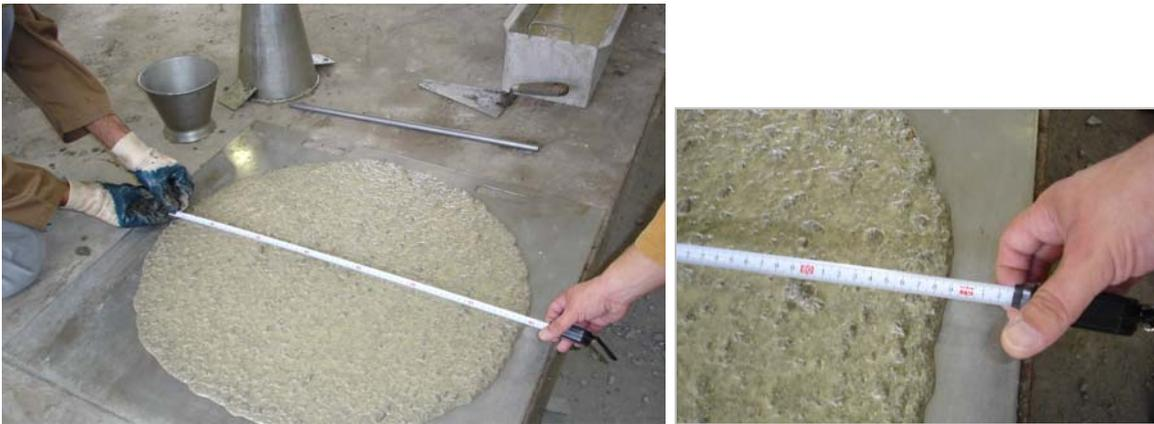
Figura 5.20 - Ensaio do Slump-flow ( 680 mm)
