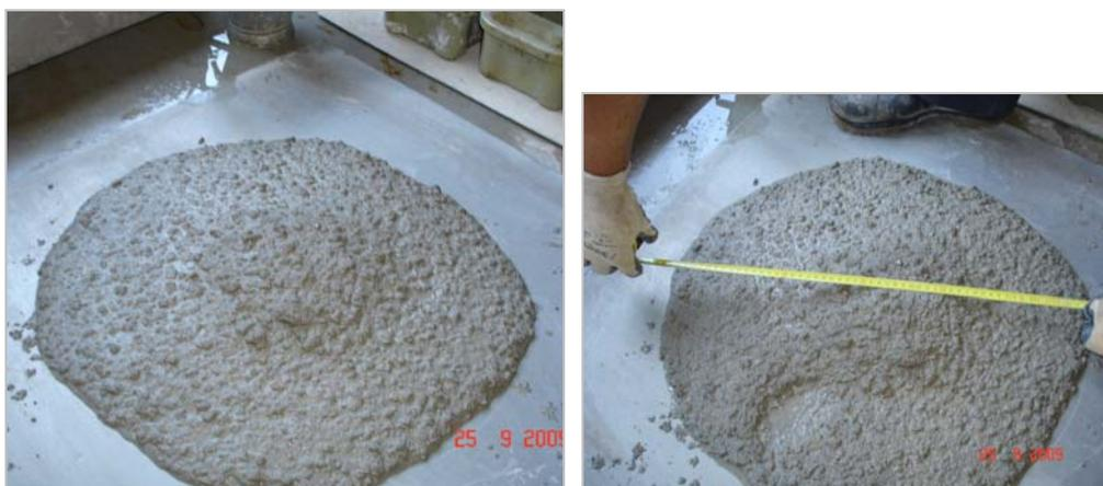
Figuras 5.9 - Ensaio do Slump-flow (590 mm). Amostra LAB 2
