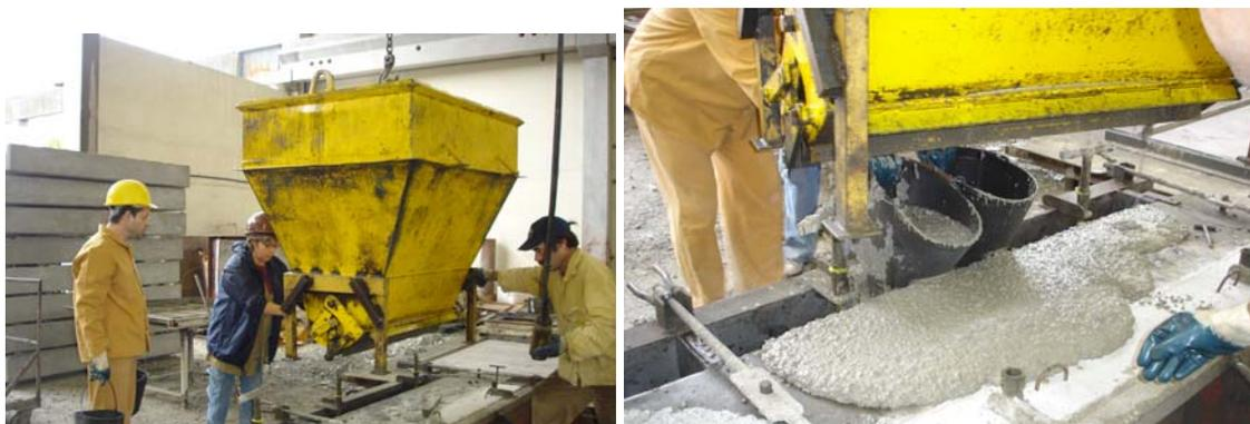
Figura 5.17 – Início da descarga do betão auto-compactável PAV 1C
