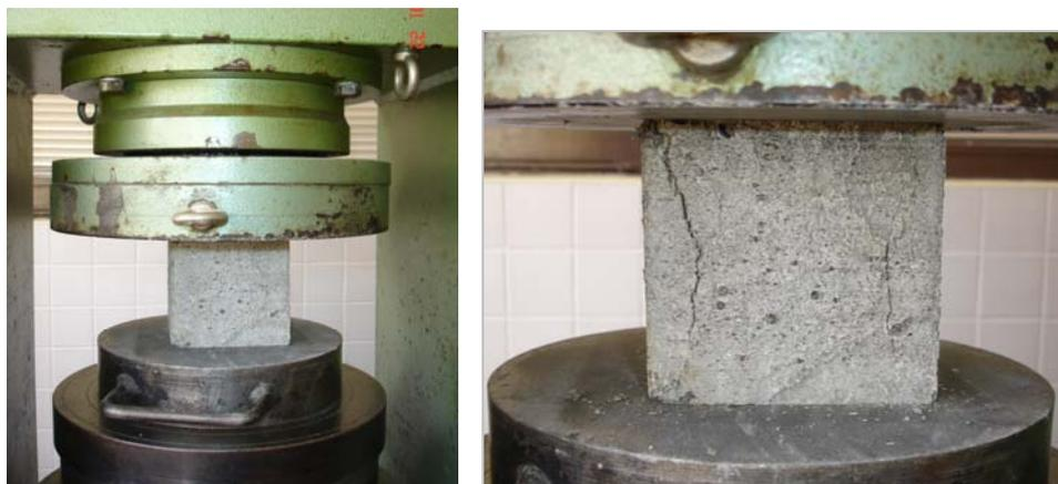
Figura 5.23 - Ensaio de resistência à compressão PAV 2 (3 dias)
