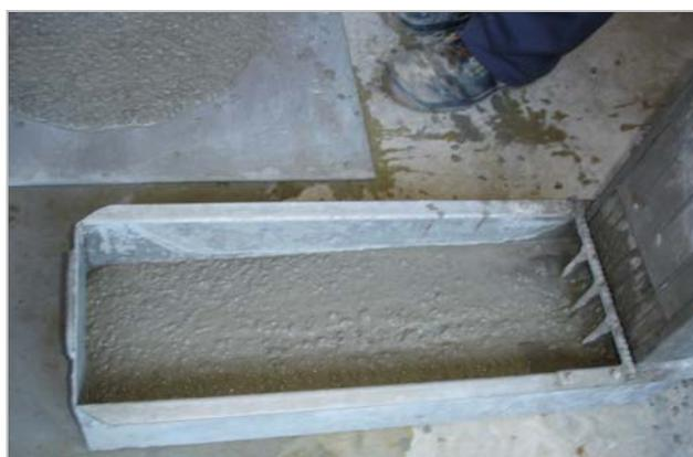
Figura 5.10 - Ensaio da L-box (72 mm) Amostra LAB 2
