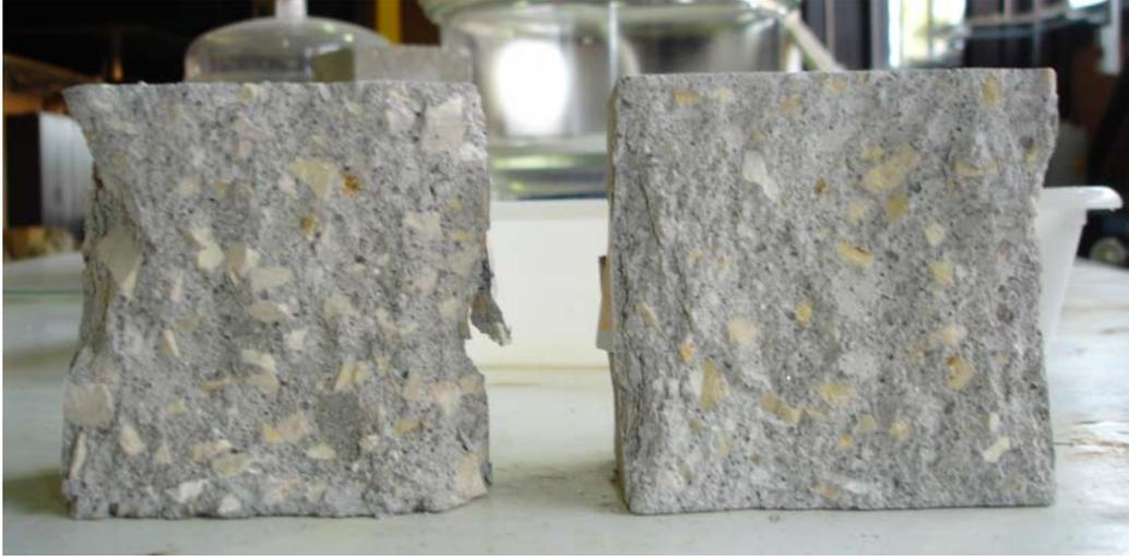
Figura 5.14 – Provete LAB 2 após o ensaio de resistência à compressão (28 dias)
