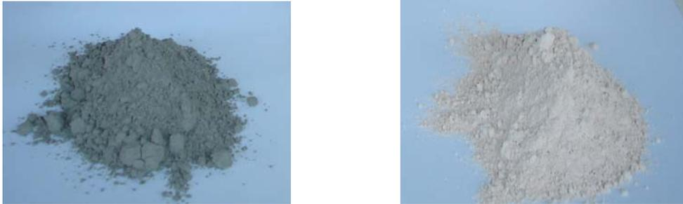
Figura 5.2- Cimento Portland Tipo I 42,5 R e Metacaulino (Cerâmica Condestável)
