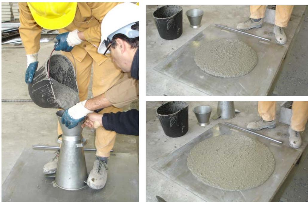
Figura 5.19 - Ensaio do Slump-flow ( 680 mm e  $T_{500}$  2s )
