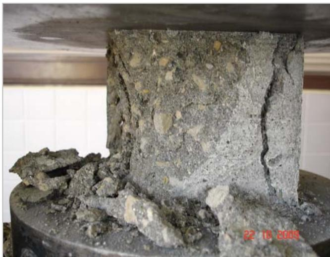
Figura 5.24 - Ensaio de resistência à compressão PAV 2 (3 dias)
