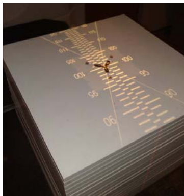
Figura 43 – Setup de irradiação dos MOSFETs no fantôma de placas de água sólida.
