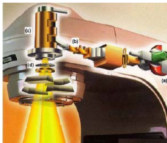
Figura 8 – (a) Magnetron; (b) Sistema de guia de ondas; (c) Tubo acelerador e (d) Alvo [7].
