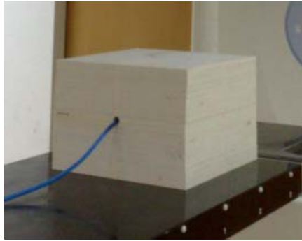
Figura 20 – Fantôma de placas de água sólida.
