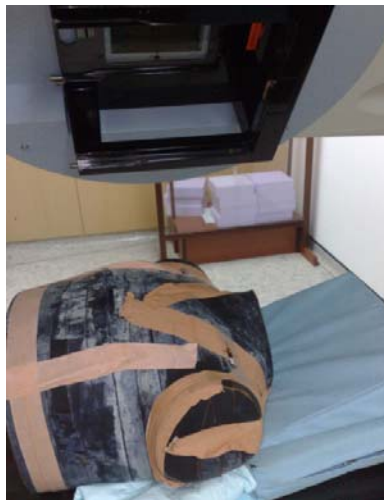
Figura 46 – Setup de irradiação dos MOSFETs no fantôma Rando.
