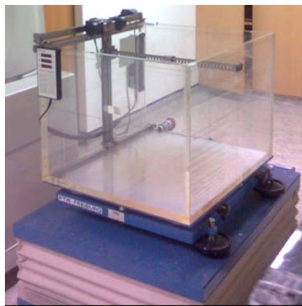
Figura 16 – Tanque de água utilizado no Controlo da Qualidade dos Aceleradores.
