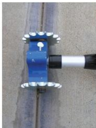
Figura 5-7 – Aparelho rotativo de percussão para identificação de anomalias no betão
