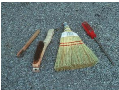
Figura 5-3 – Ferramentas de limpeza e auxílio na Inspeção
