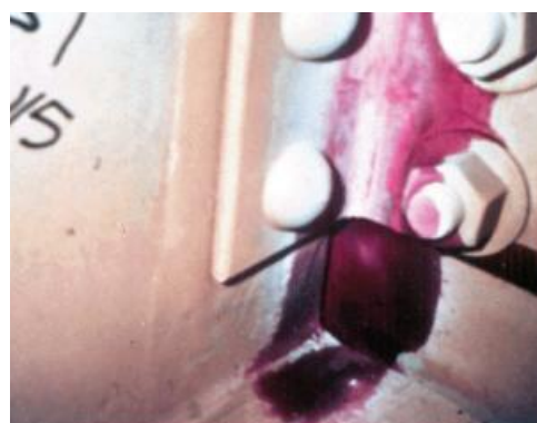
Figura 5-12 – Ensaios com tinta penetrante
