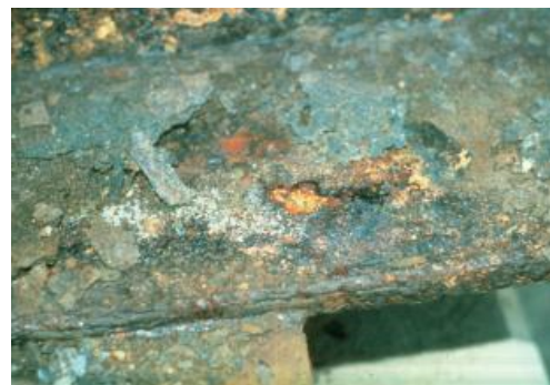
Aço patinado sem protecção Película oxidante com cor preta
