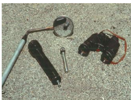
Figura 5-2 – Equipamentos de auxílio visual numa Inspeção (Fonte: Bridge Inspector's Reference Manual, 2006)
