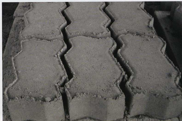
Figura 7. Blocos de pavê em betão com resíduos de borracha [24]
