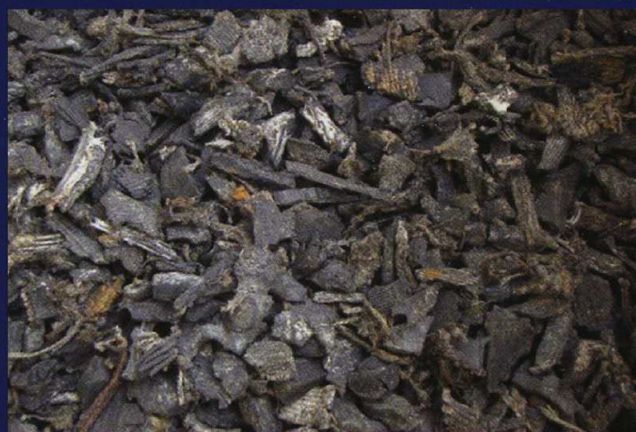
Figura 4. Agregados de borracha reciclados à saída do processo de trituração [9]
