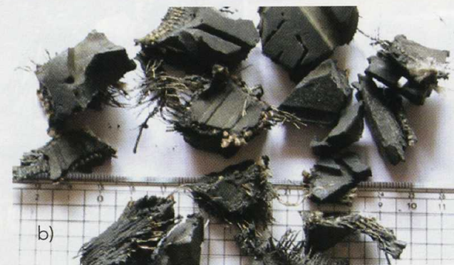
Figura 6. Agregados de borracha reciclada: a) Moída; b) Triturada [21]
