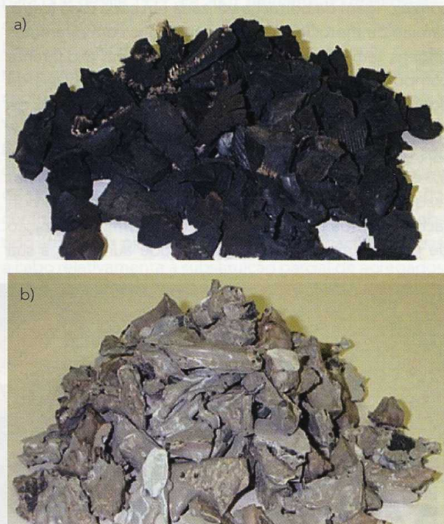
Figura 5. Agregados de borracha com 20 mm: a) Normais; b) Cobertos com pasta de cimento [16]
