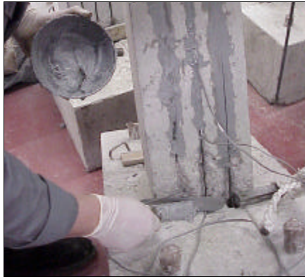
Figura 20 - Fixação dos laminados a um elemento de pilar.
