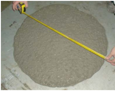
Fig. 1. Ensaio de espalhamento com o cone de Abrams.
