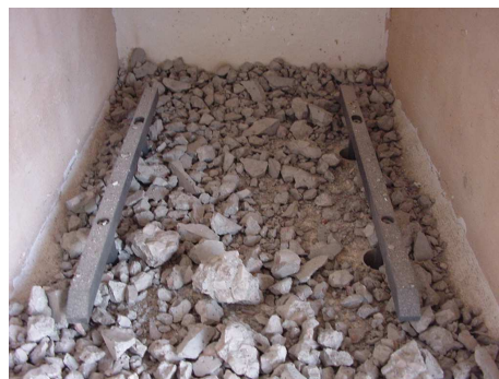
Figura 21 – Spalling explosivo ocorrido nos provetes cúbicos da série Referência
