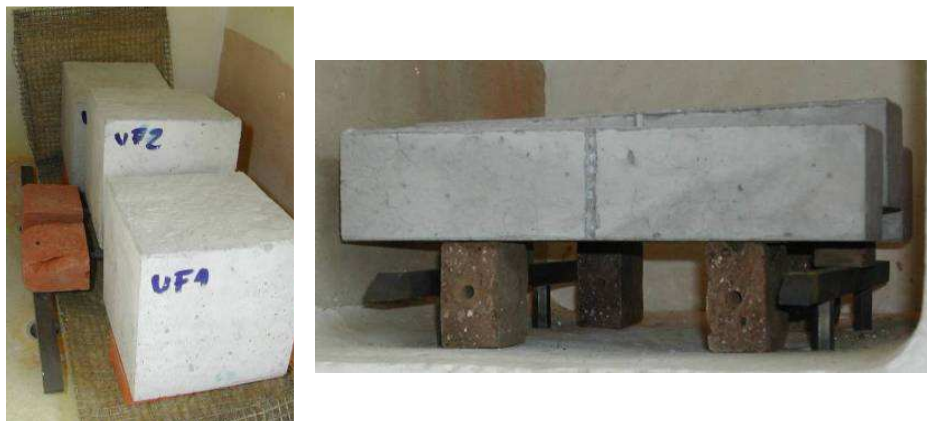
Figura 17 – Disposição dos provetes no interior do equipamento
