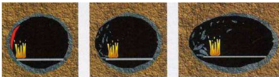
Figura 3 – Sequência da destruição de um túnel pela acção de fogo
