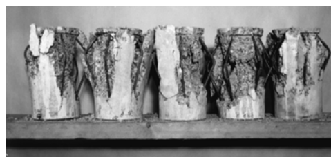
Figura 3 - Configuração de rotura dos provetes da série C270_30.
