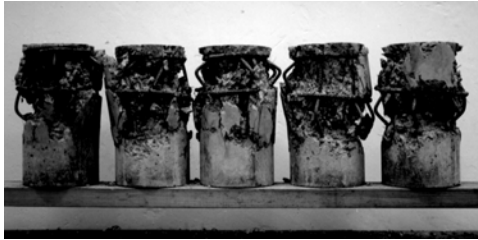
Figura 4 - Configuração de rotura dos provetes da série C90_30.
