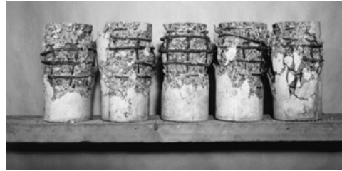
Figura 5 - Configuração de rotura dos provetes da série C38_30.
