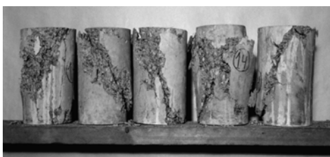
Figura 2 - Configuração de rotura dos provetes da série C00_30.
