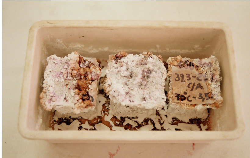
Figura 5 – Provetes de argamassas aditivadas cobertos com cristais de carbonato sódio
