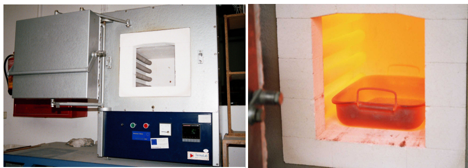
Figura 1. Tratamento térmico das lamas residuais: a) Forno estático; b) arrefecimento brusco das lamas
