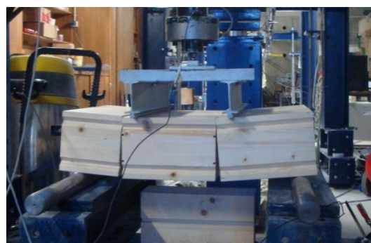
Figura 14 – Deformação típica das paredes durante o ensaio de flexão das juntas verticais
