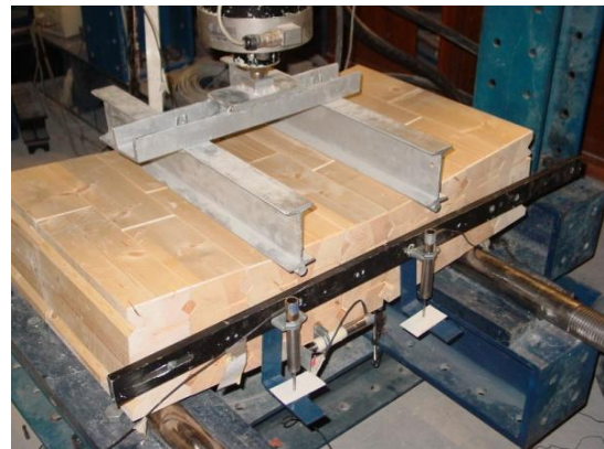
Figura 11 – Deformação típica das paredes durante o ensaio de flexão das juntas horizontais
