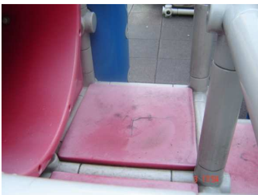
Fotografia nº 10 - Plataforma do equipamento danificada
