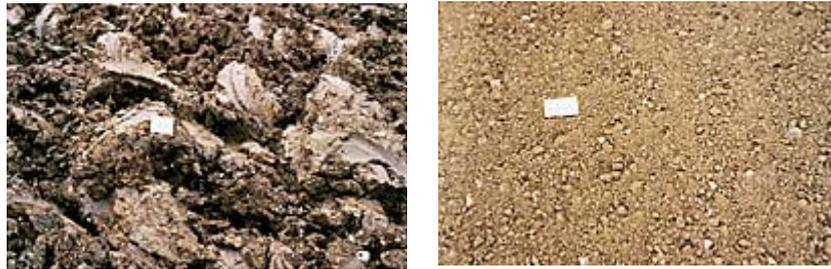
Figura 4.3: Alteração da textura de um solo argiloso devido à adição de cal
