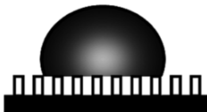
Figura 2. Representação do comportamento duma gota sobre uma superfície superhidrofóbica no modelo de Cassie – Baxter (Gang et al., 2010).
