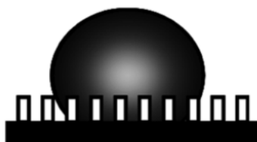
Figura 1. Representação do comportamento duma gota sobre uma superfície superhidrofóbica no modelo de Wenzel (Bico et al., 2002).
