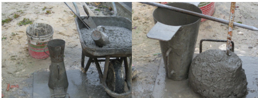
Figura 2.9 - Ensaio de abaixamento realizado em obra
