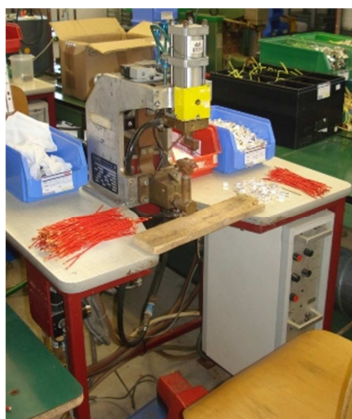
Figura 11 - Posto de soldadura do borne (Gewiss, 2011)
