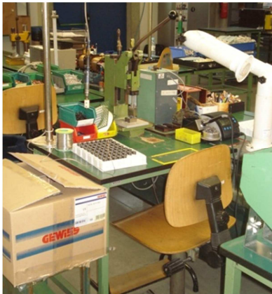
Figura 21 - Posto de pré-montagem dos relés (Gewiss, 2011)
