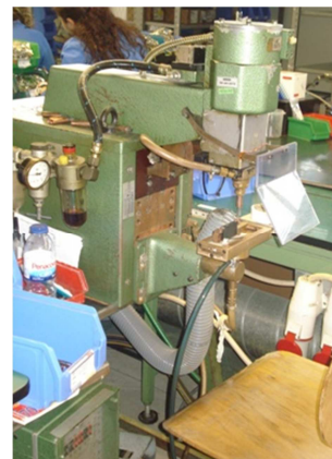
Figura 18 - Posto de soldadura do circuito de terra (Gewiss, 2011)
