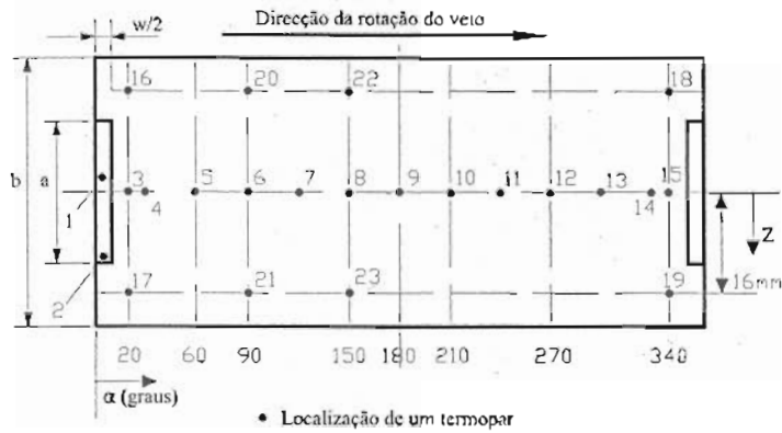
Fig. 5. Distribuição de termopares para a medição da temperatura da face interna da chumaceira
