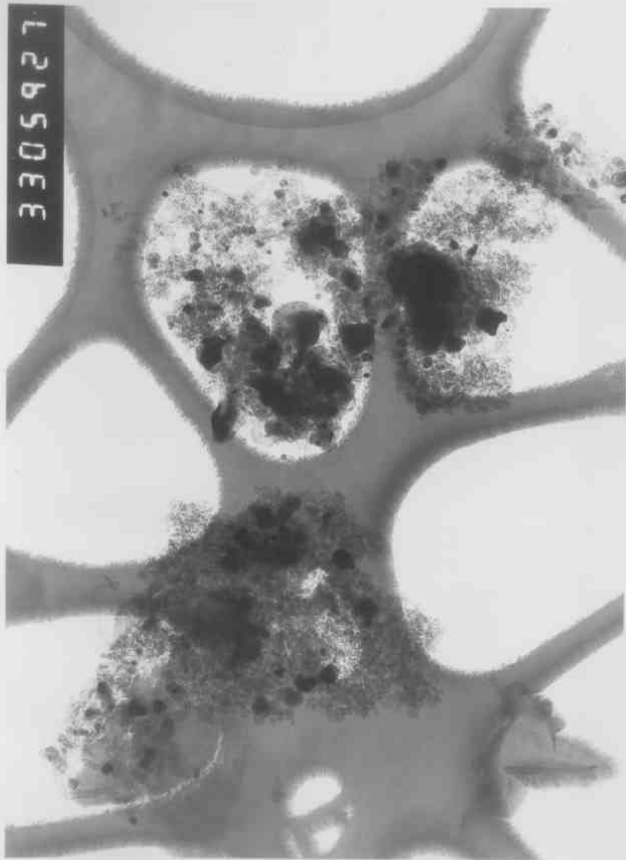
Fotografia 4.2 - Filamentos obtidos após gasificação: quase total dos depósitos formados em \text{CO}/\text{CO}_2 , em \text{Ni}/\text{SiO}_2 . Ampliação 99 000x.
