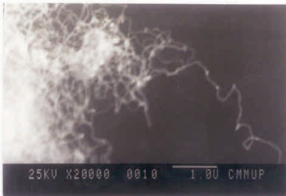
Fotografia 3.2 - Carbono filamentar ex - CO, depositado num catalisador 0.1% Cu - 99.9% Ni, suportado (53 mg de depósito). Ampliação 20 000x.
