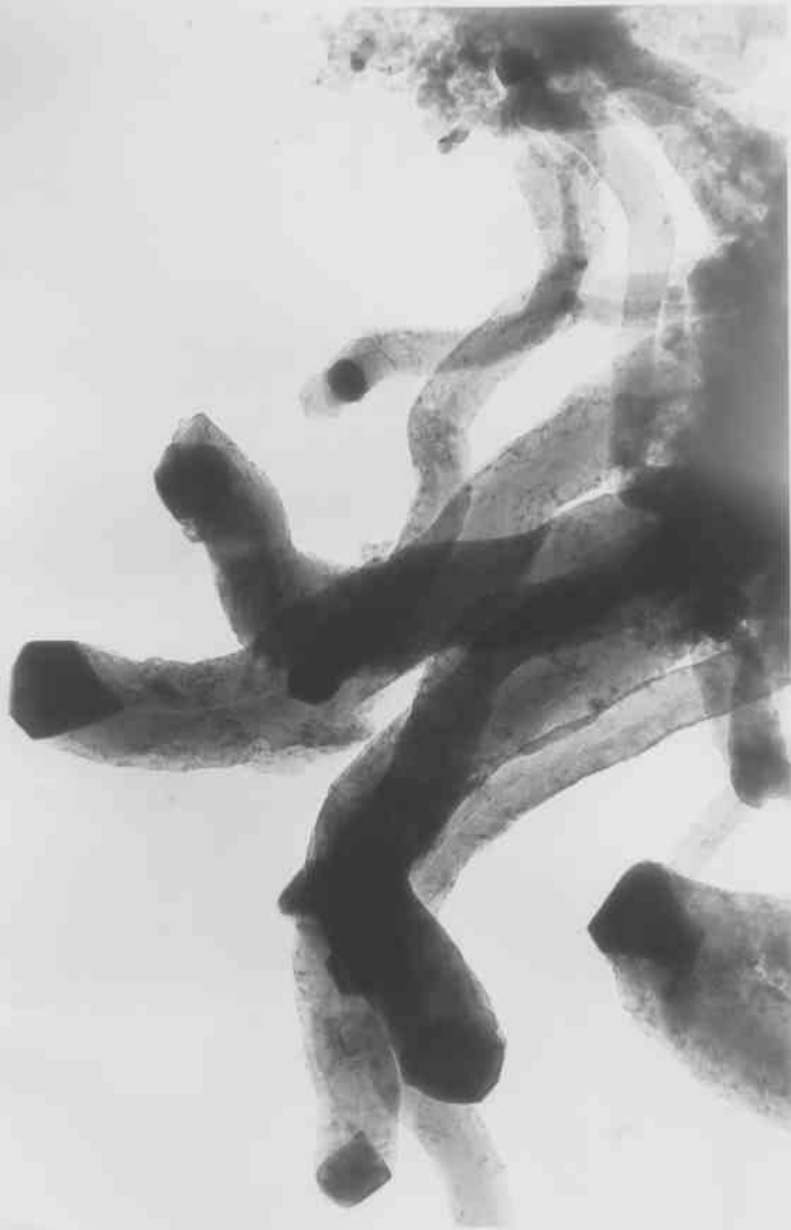
Fotografia 4.3 - Partículas metálicas activas na decomposição do metano. Ampliação 105 000x.
