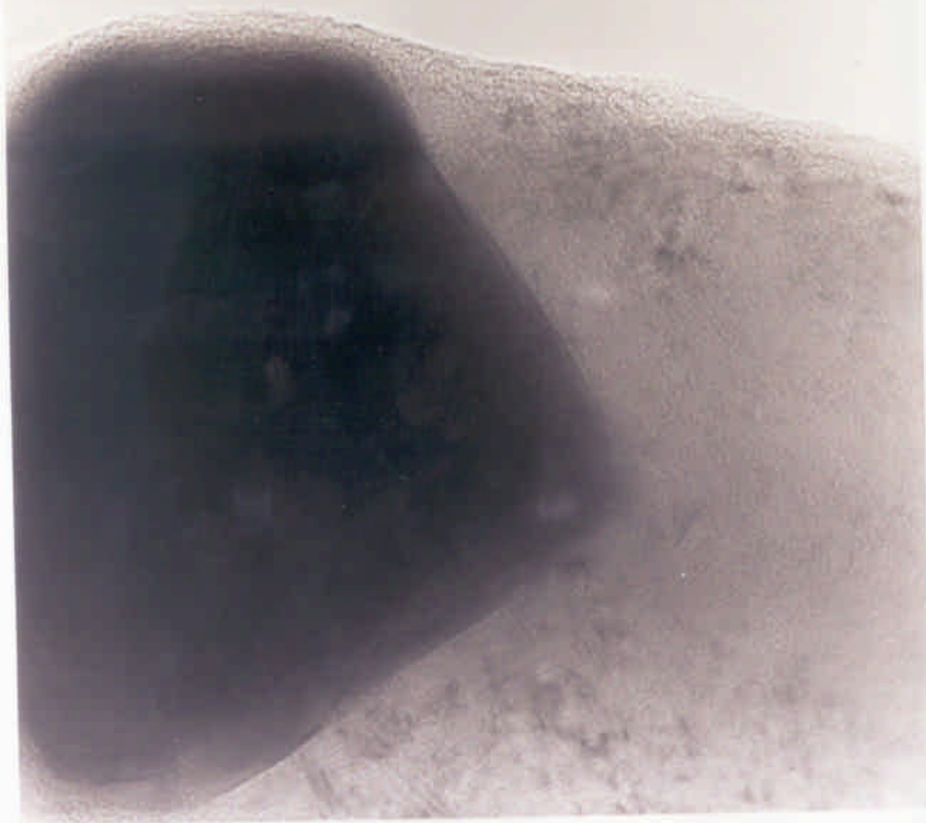
Fotografia 3.5 - Microscopia electrónica de alta resolução. Catalisador com 100% Ni/SiO 2 , depositado a 763 K em atmosfera CH 4 /H 2 . Ampliação 1 650 000 x
