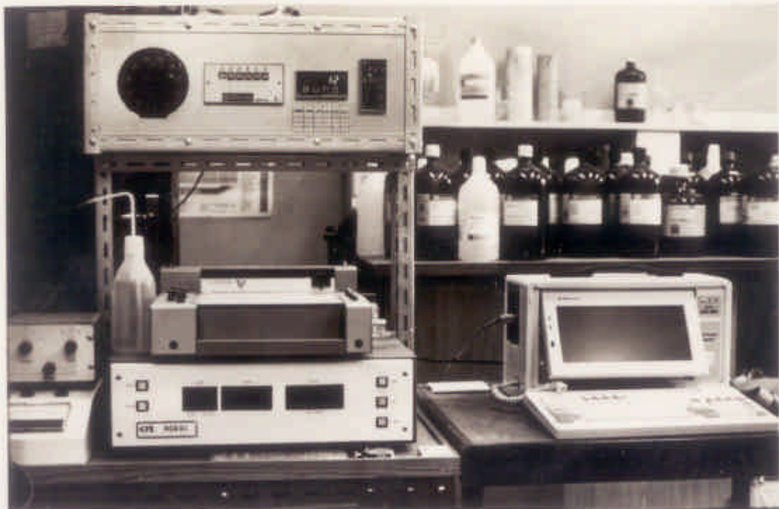
Figura 2.2 - Montagem laboratorial onde se realizaram os ensaios relativos à decomposição de CO e à metanação.
