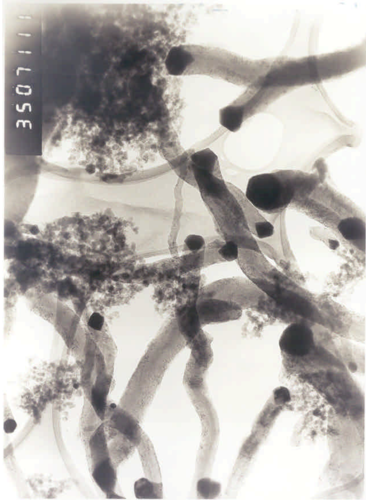
Fotografia 3.6 - Facelamento de partículas metálicas. Catalisador com 100% Ni/SiO 2 , depositado a 763 K em atmosfera CH 4 /H 2 . Ampliação 105 000 x.
