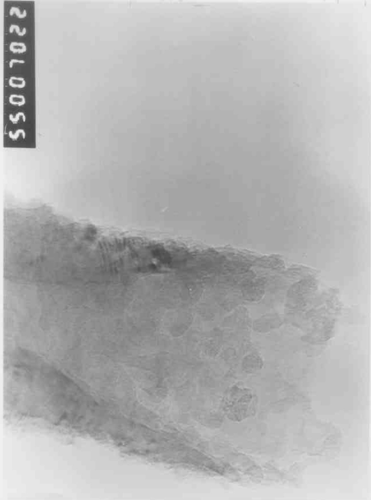
Fotografia 4.4 - Evidência de facetingo das partículas dos catalisadores utilizados na decomposição do motor. Ampliação: 1 650 000x.
