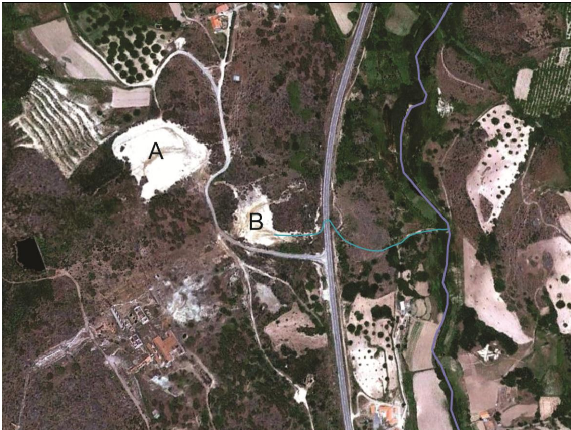
Figura 3.9 – Vista aérea da área em estudo de Penedono. A e B representam as escombreiras, a linha a azul claro mostra o percurso do efluente e a linha a azul mais escura representa a Ribeira da Granja (extraído de GoogleEarth®)
