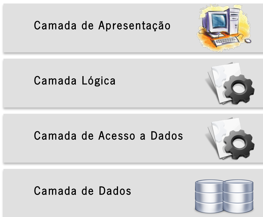
Figura 7 - Arquitetura utilizada no desenvolvimento da aplicação SUTE.
