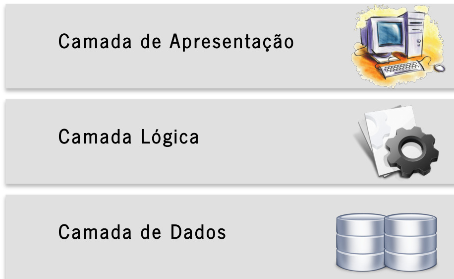
Figura 17 - Arquitetura de 3 camadas utilizada na Aplicação Web
