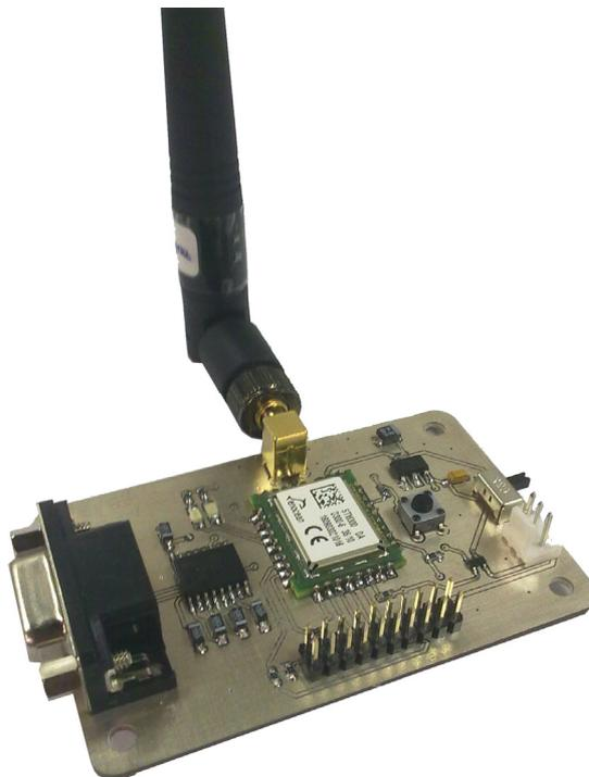
**Figura 4.5:** Protótipo que implementa o coordenador usando tecnologia *Enocean*
