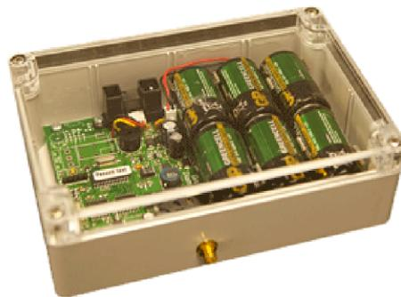
**Figura 2.3:** Sensor instalado no interior dos contentores
