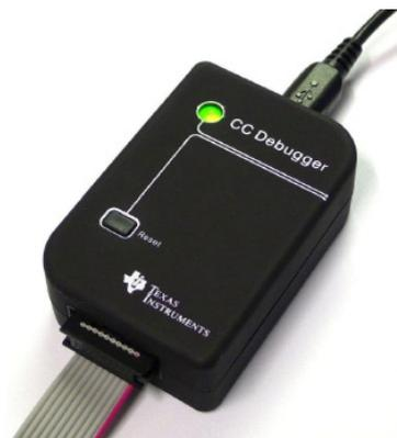
**Figura 4.3:** CC-DEBUGGER da *Texas Instruments*
