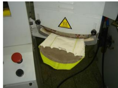
Figura 35 – Moldar a gáspea na frente aplicando calor
