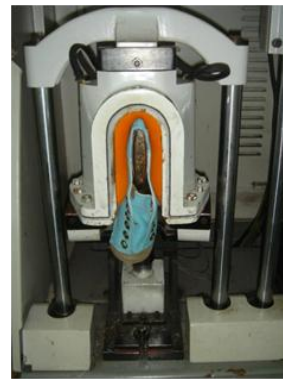
Figura 38 – Moldar a gáspea atrás aplicando frio
