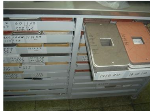
Figura 26 – Estante de armazenamento dos moldes
