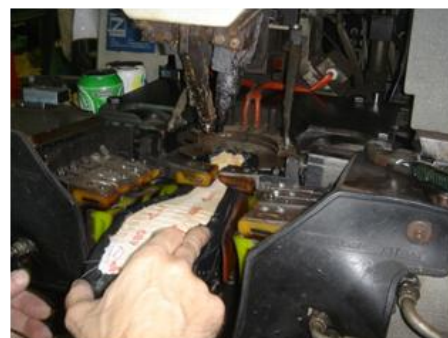
Figura 48 – Colagem do couro à palmilha
