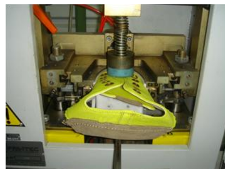
Figura 36 – Moldar a gáspea na frente aplicando frio
