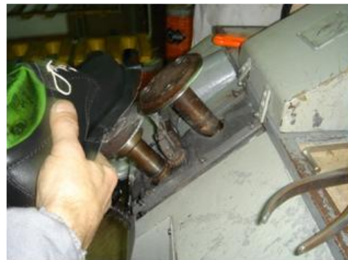
Figura 58 – Dobragem do couro na máquina de vincar
