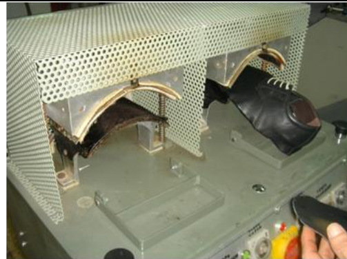
Figura 57 – Aplicação de calor na gáspea
