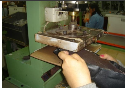
Figura 31 – Processo de colar testeiras
