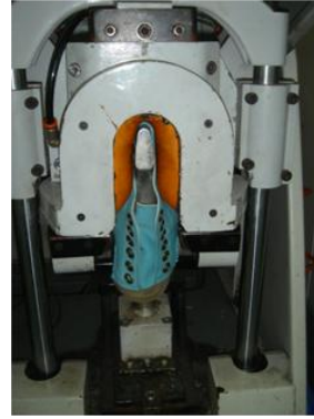
Figura 37 – Moldar a gáspea atrás aplicando calor
