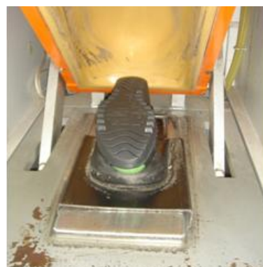
Figura 51 – Acoplamento da sola à gáspea
