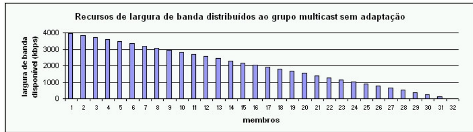
Figura 7 - Simulação de escalabilidade do grupo numa sub-rede sem aplicação de adaptabilidade.
