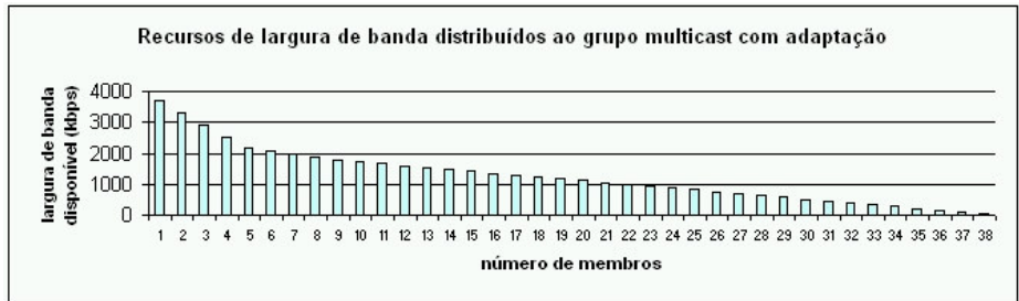
Figura 8 - Simulação de escalabilidade do grupo na mesma sub-rede com aplicação de adaptabilidade.
