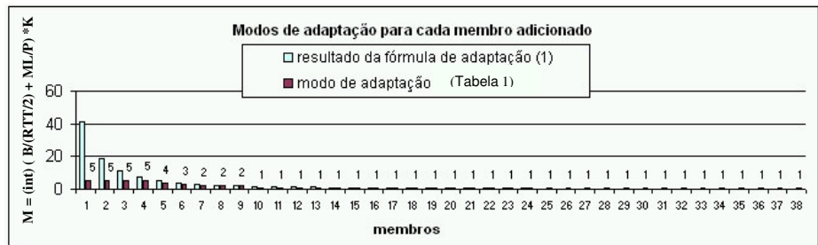
Figura 9 - Modos de adaptação produzidos para cada novo membro emissor do grupo multicast da figura anterior.
