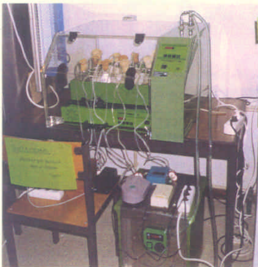
Fig. 3.1. Aspecto da montagem utilizada no crescimento das leveduras mantendo o arejamento constante.
