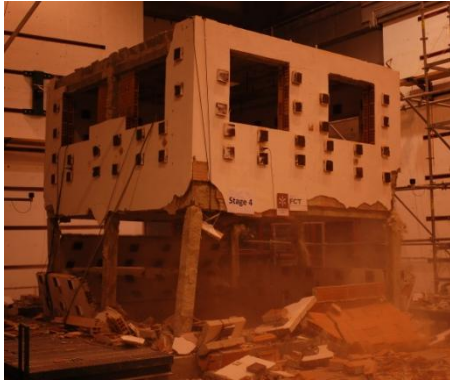
(c) Rótulas no topo dos pilares do primeiro piso a fachada Oeste
