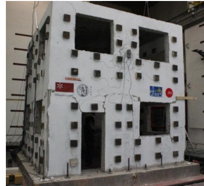
(b) Aspeto geral do modelo após o ensaio e fendilhação ao longo da viga do primeiro piso na fachada Norte
