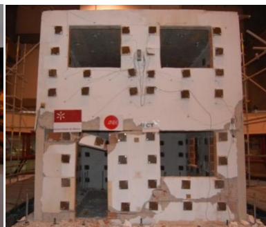
(b) Pano do primeiro piso com dano extremo e pano do segundo piso com dano ligeiro
