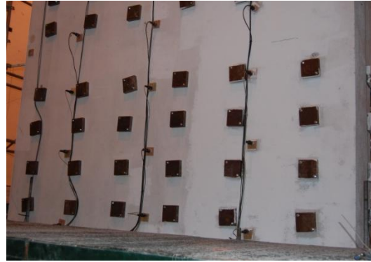
(b) Acelerómetros nas paredes de enchimento
