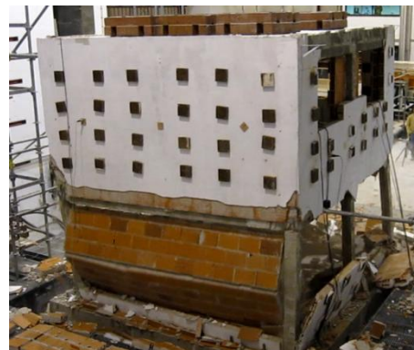
(b) Colapso de um pano interior
