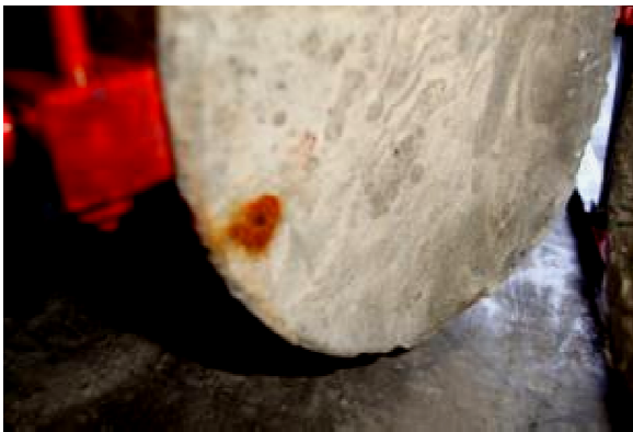
Figura 22 – Rompimento da fibra de aço devido à ação da corrosão
