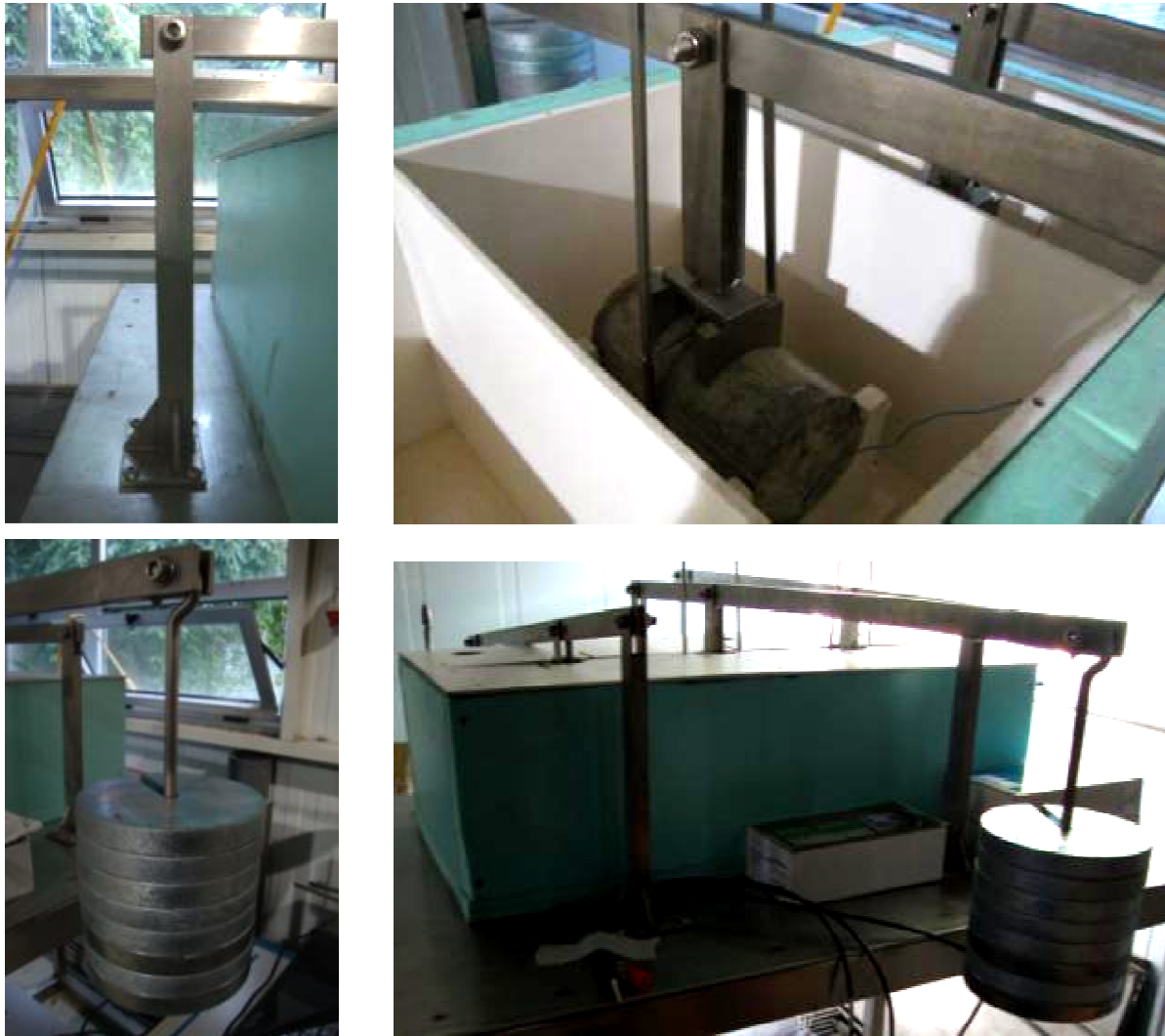
Figura 15 – Aspeto do sistema de aplicação de força
