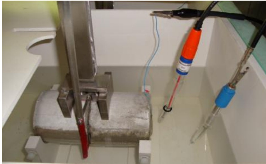
Figura 19 – Célula eletroquímica para realização do ensaio OCP
