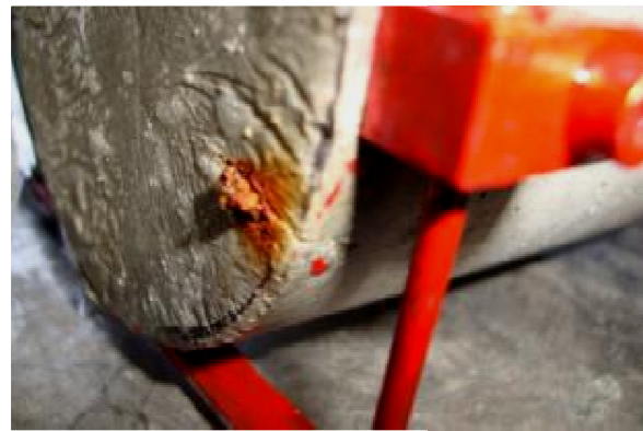
Figura 22 – Rompimento da fibra de aço devido à ação da corrosão
