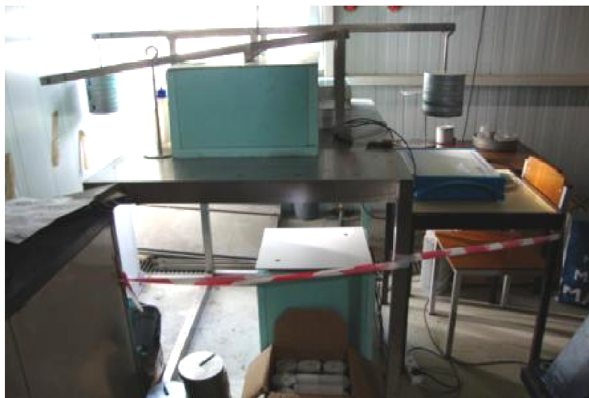
Figura 21 - Ensaio a decorrer de arrancamento de fibras sujeitas à ação da corrosão
