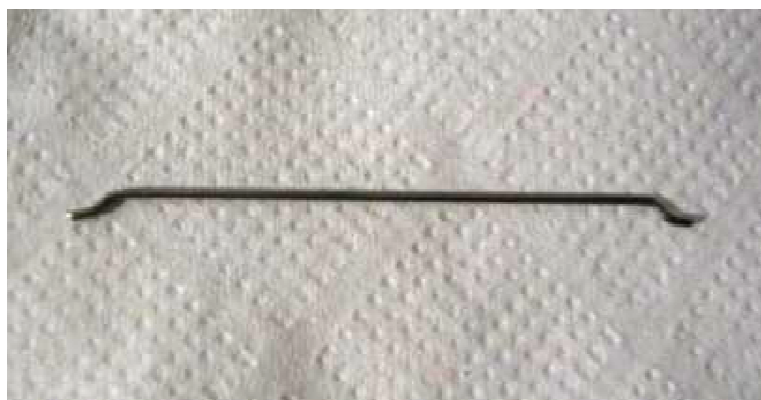
Figura 2 – Fibra de aço RC 65/60 BN da Dramix
