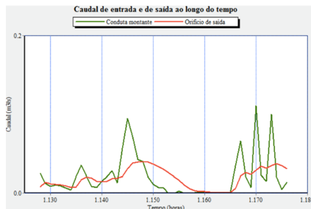
Figura 3: Desfasamento temporal entre o caudal de entrada e de saída.
