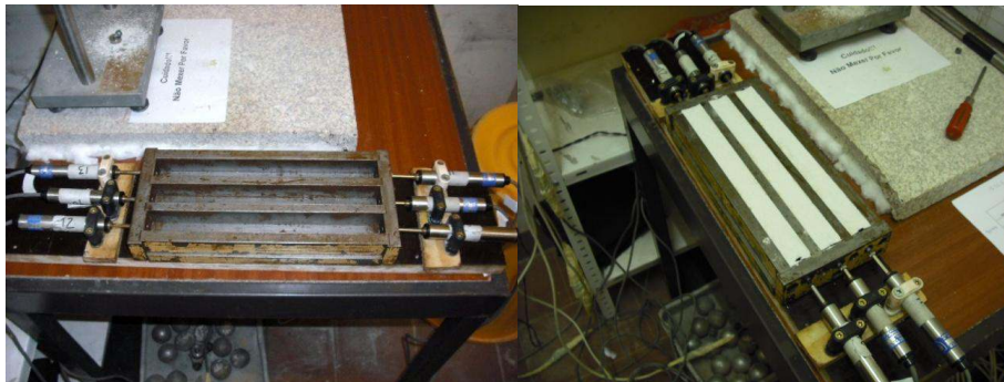
Figura 4 – Dispositivo de medição da retração das argamassas no estado fresco
