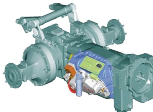
Figura 17 - Transmissão ZF modelo S-Matic
