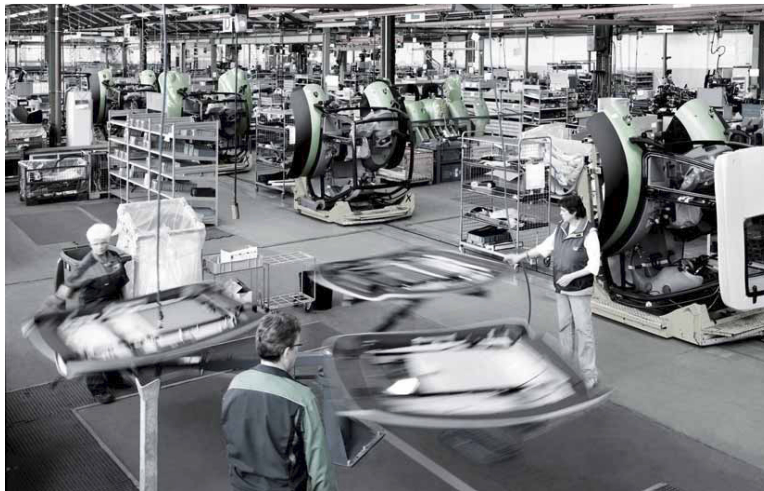
Figura 10 - Montagem da cabina
