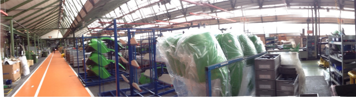
Figura 32 - Posto de montagem dos guarda-lamas.
