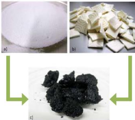
Fig.2_Aspecto dos produtos iniciais: a) PVC puro em pó e b) resíduo com PVC e c) do produto final após pirólise.
