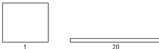
Figura 3.5 - Exemplo de *Aspect Ratio* em quadriláteros
