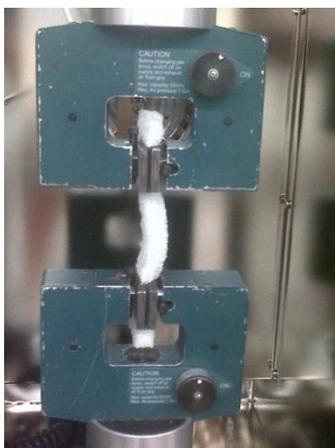
Figura 9 - Ensaio de tração da espuma de memória de forma.
