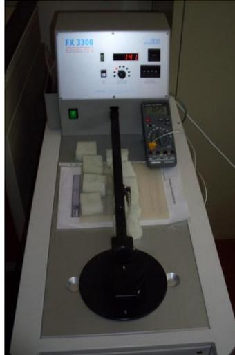
Figura 7 Equipamento de teste de permeabilidade de pressão de ar FX 3300-PNA
