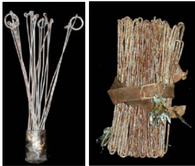
Figura 1 – Dois exemplos de cadeias de agrimensor usadas para medir grandes áreas.
