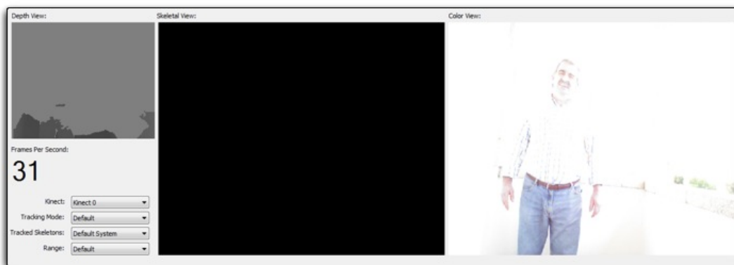
Figura 4.26 – Demonstração do funcionamento do sensor de profundidade quando exposto diretamente sobre a luz do sol.
