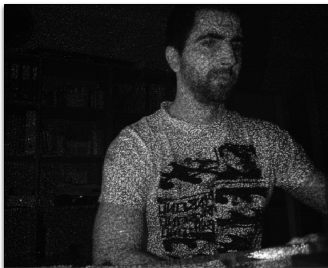
Figura 4.3 - Processo de lightcoding através de uma imagem obtida pelo sensor de profundidade com pontos de infravermelhos emitidos pelos emissor de infravermelhos.
