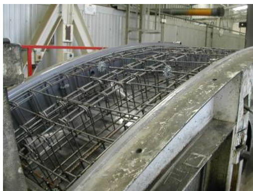
Figura 3.38 – Armadura convencional em aduelas pré-fabricadas para o revestimento de túneis
