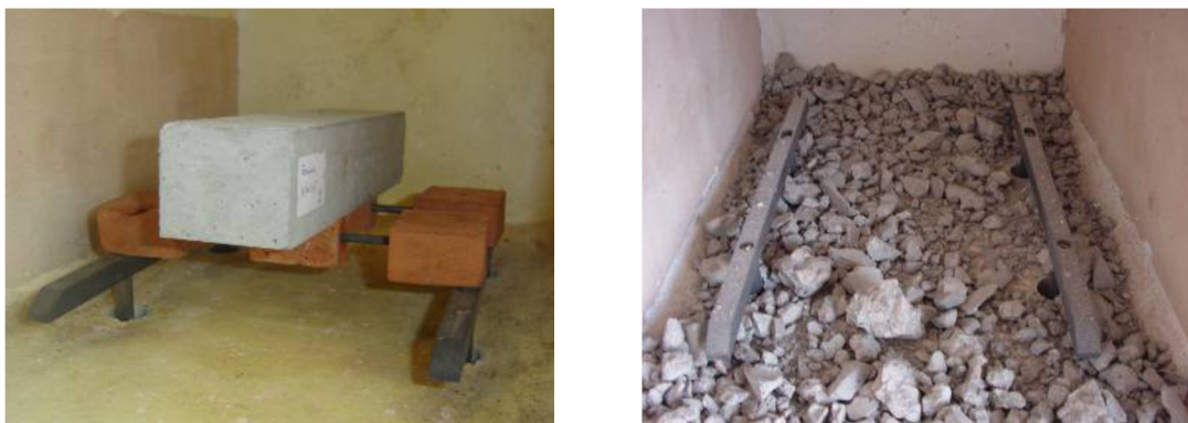
Figura 2.23 – Desintegração de provete de betão quando exposto a temperaturas elevadas
