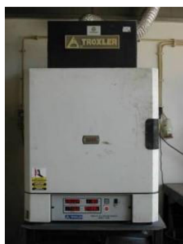
Figura 2.25 – Exposição dos provetes ao nível de temperatura pretendido
