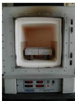
Figura 2.25 – Exposição dos provetes ao nível de temperatura pretendido
