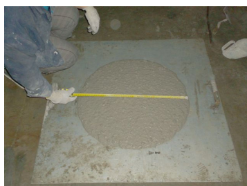
Figura 4.23 – Espalhamento do BACRF
