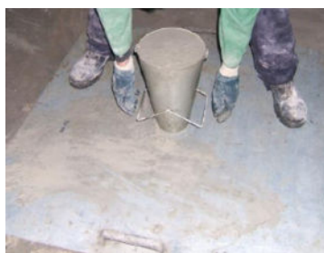
Figura 2.3 – Enchimento do cone de Abrams
