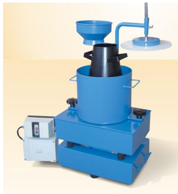
Figura 2.2 – Equipamento e esquema de montagem do ensaio Vêbê
