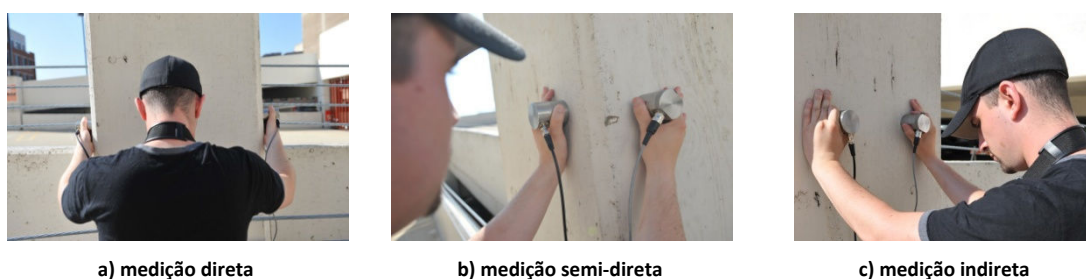
Figura 2.46 – Vários tipos de medição de UPV ( www.ndtjames.com )
