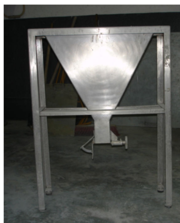
Figura 2.11 – Realização do ensaio de fluidez (abertura da comporta)
