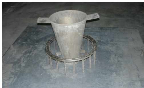
Figura 2.14 – Combinação da utilização do anel japonês com o cone de Abrams
