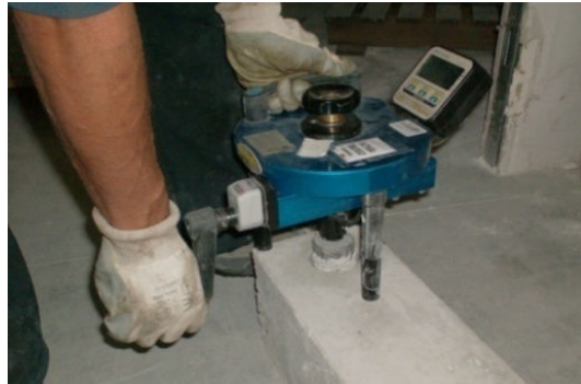
Figura 2.53 – Equipamento de pull-off (Cunha et al., 2012)
