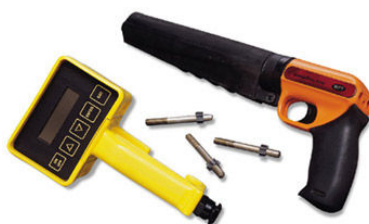
Figura 2.48 – Equipamento para realização do ensaio de penetração (www.worldoftest.com)
