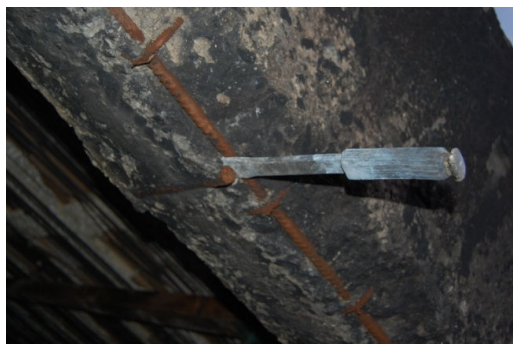
Figura 6.34 – Recolha de amostras de varões de aço
