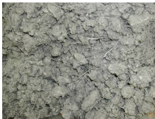
Figura 3.39 - Betão reforçado com fibras utilizado em aduelas pré-fabricadas para o revestimento de túneis
