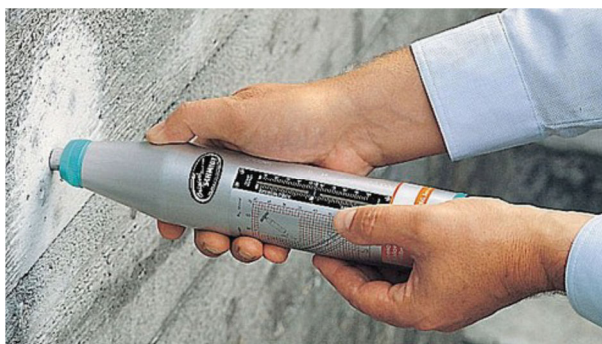
Figura 2.44 – Aplicação do esclerómetro de Schmidt
