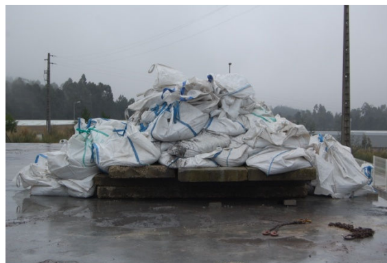
Figura 6.40 – Segunda fase (carga com placas em betão e sacos de brita)
