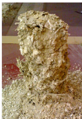
Figura 4.2 – Desagregação de um provete cilíndrico após exposição térmica (1000 °C)
