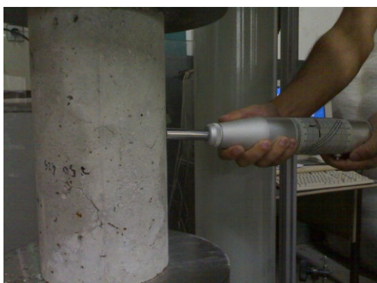
Figura 5.1 – Previsão de resistência recorrendo ao esclerómetro de Schmidt (aplicação de pré-carga)
