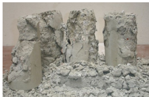
Figura 4.33 – Desintegração dos provetes de BACRF submetidos a T_{max} = 800^\circ\text{C}
