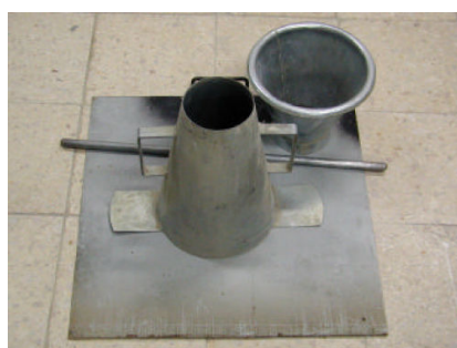
Figura 2.1 – Equipamento do ensaio de abaixamento
