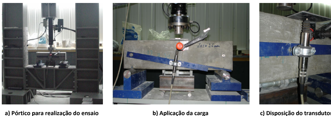
Figura 2.18 – Configuração do ensaio de caracterização do BRFA à flexão
