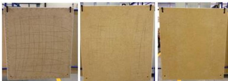
Figura 25 - Teste da grafite (peça c/ lápis; lixagem NOK; lixagem OK).
