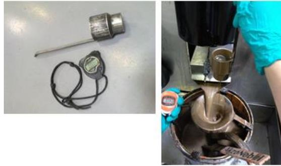
Figura 26 - Processo de controlo da viscosidade.
