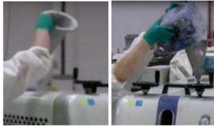
Figura 64 - Colocação do funil e líquido de limpeza
