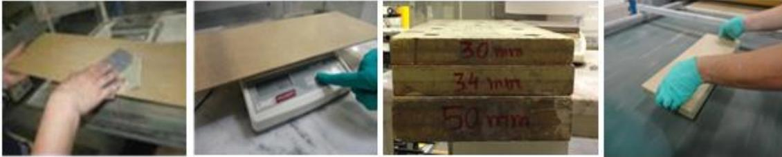
Figura 27 - Processo do controlo de medição de gramagem.
