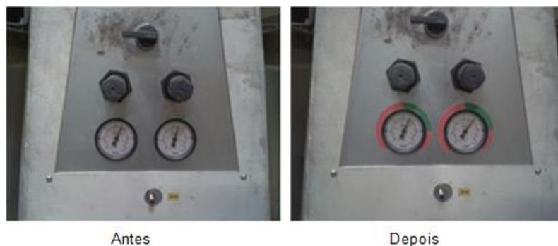
Figura 83 - Manómetros visuais na tensão da lixa (antes e depois)
