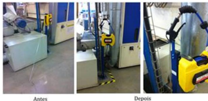
Figura 74 - Suporte para pistolas de ar comprimido (antes e depois)
