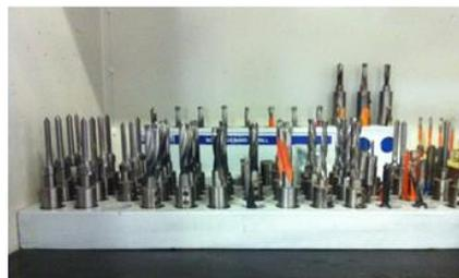
Figura 52 - Suporte para colocação de brocas de cabeços
