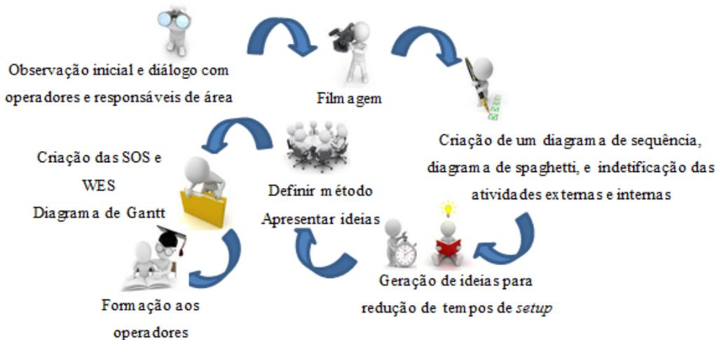
Figura 43 - Sequência adotada com base na metodologia SMED
