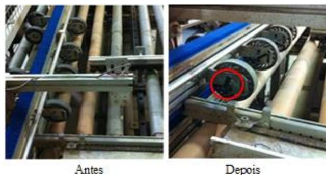
Figura 48 - Apertos rápidos nas rodas da saída da inspeção (antes e depois).
