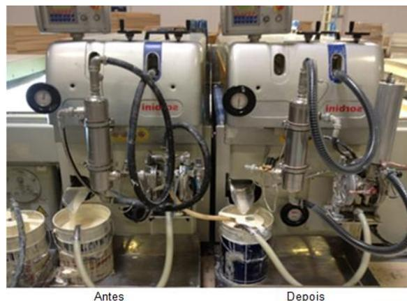
Figura 78 - Cobertura de plástico para tubos de tinta (antes e depois)
