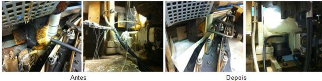
Figura 79 - superfície de Teflon para rolos da cola (antes e depois)
