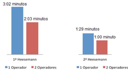
Figura 55 - Tempo previsto para troca com 1 operador e 2 operadores.
