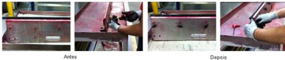
Figura 65 - Apertos rápidos nas facas do *Printing* (antes e depois)
