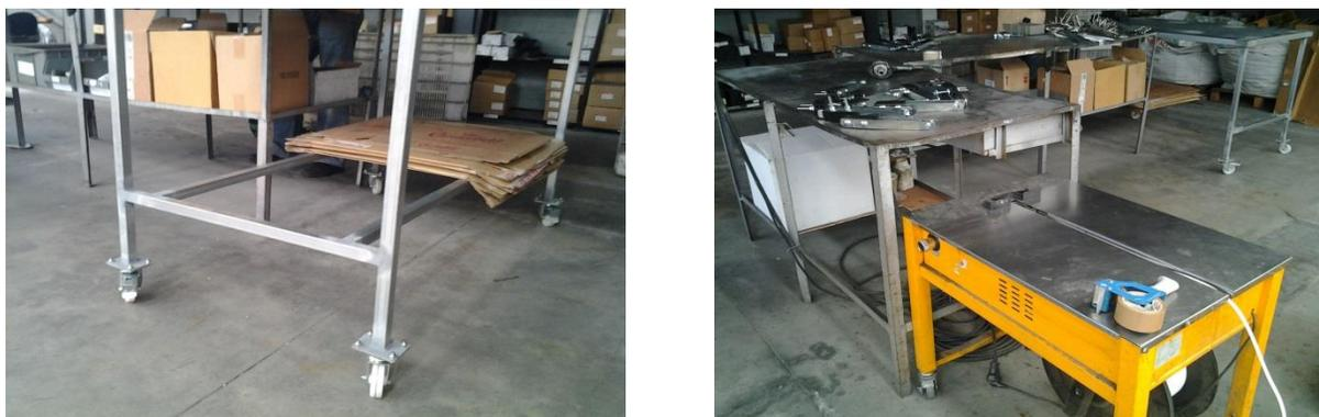
**Figura 87 – Aplicação de rodas com e sem travão na mesa de montagem**
