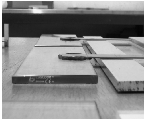
Fig. 2: Pormenor do espaçador e da ligação adesiva
