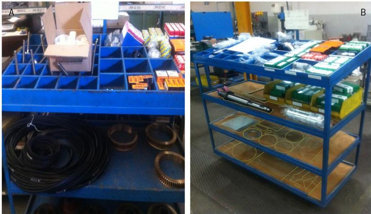
**Figura 42 – Carro de transporte de componentes. A – antes de implementação; B – após implementação**
