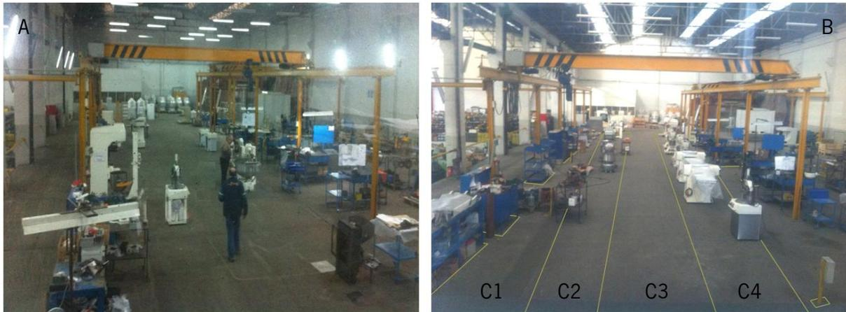
**Figura 41 – Marcações Visuais na Secção de Montagem. A - antes da implementação; B - depois da implementação**
