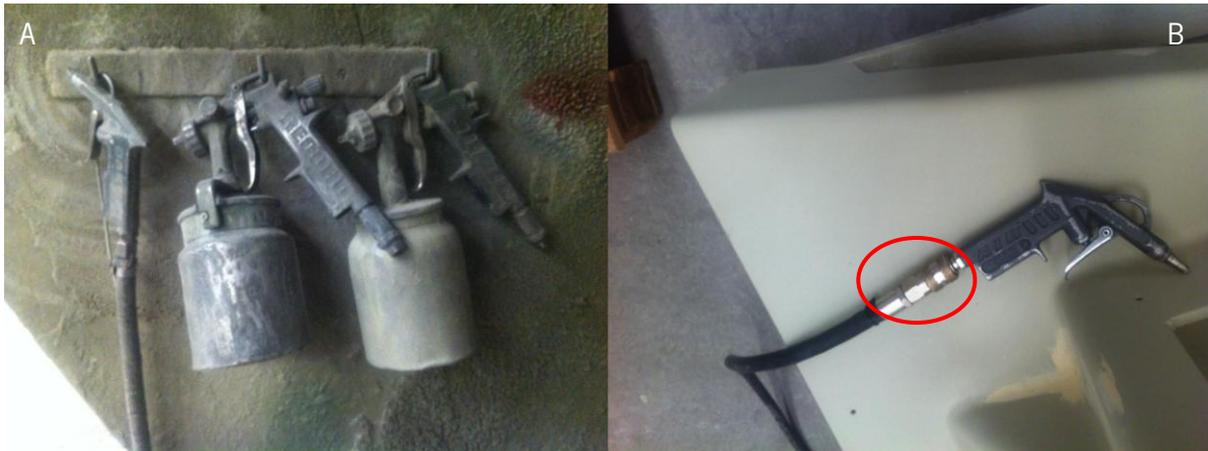
**Figura 43 – Racords de substituição rápida. A – sem racord; B – com racord**
