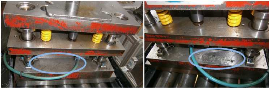
Figura 48: Cunhos sem identificação (à esquerda) e com identificação (à direita)
