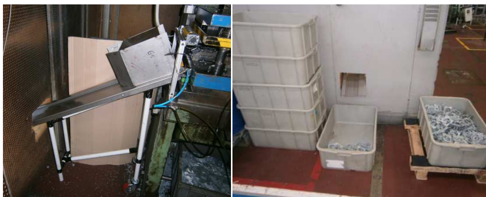
Figura 61: Calha de orientação e transporte de peças
