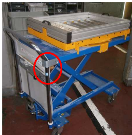
Figura 40: Carro de transporte melhorado
