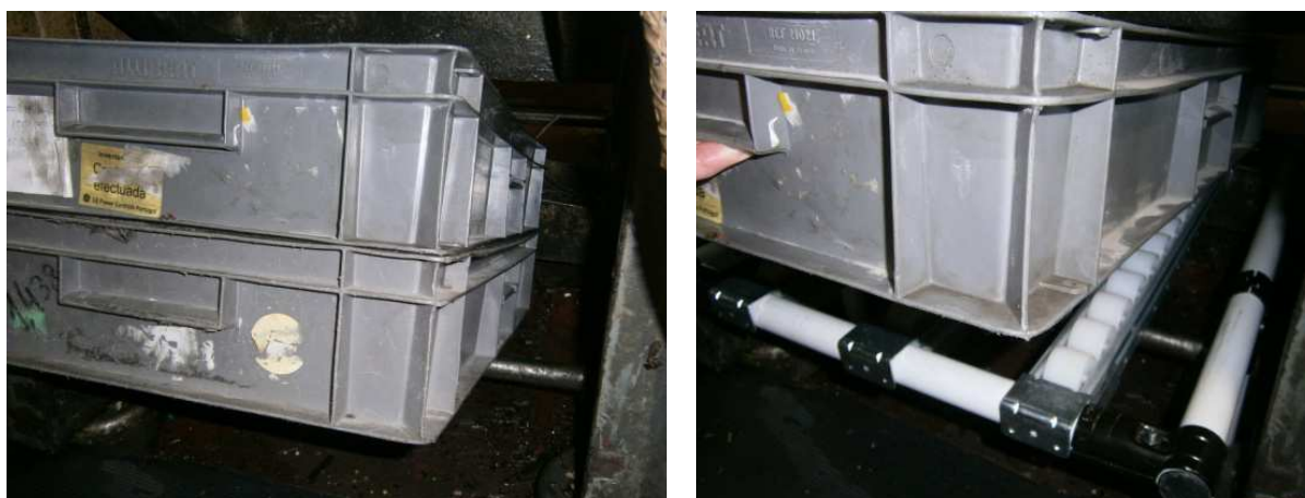
Figura 50: Contentor de sucata sem suporte (à esquerda) e com suporte (à direita)
