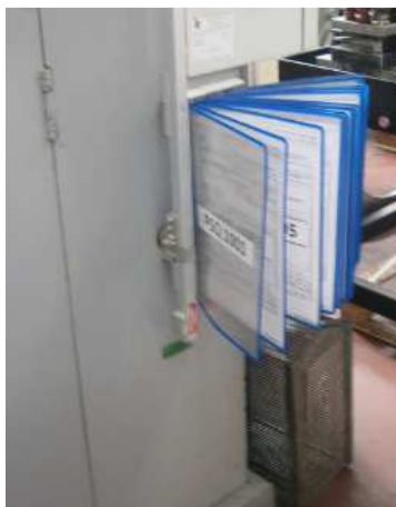
Figura 38: Documentação colocada na PMAU para reduzir as deslocações dos operadores
