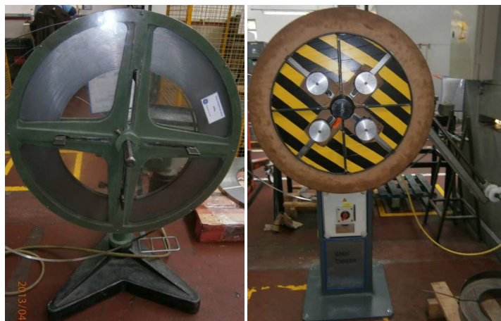
Figura 49: Desenroladores, antigo (à esquerda) e novo (à direita)
