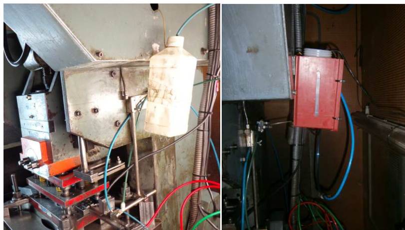
Figura 51: Sistema de lubrificação através do ar (à esquerda) e através da bomba de líquidos (à direita)
