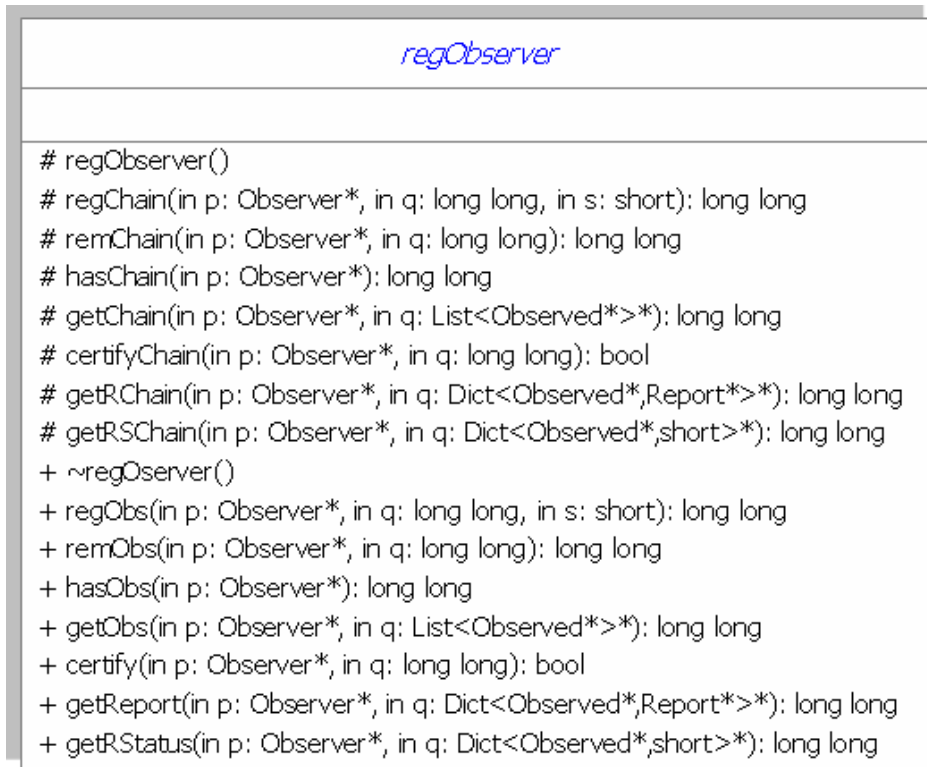
Figura 6.4: Redefinição da interface regObserver , por forma a implementar os mecanismos necessários à emissão de relatórios.
