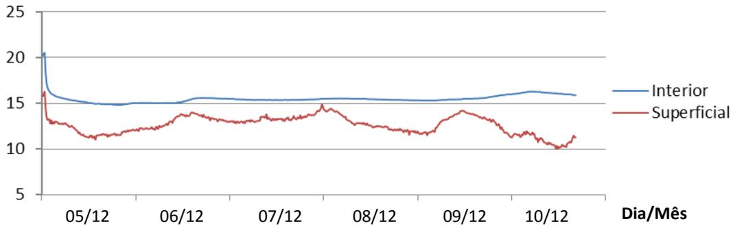
Figura All.21 – Temperatura medida no edifício CS8.
