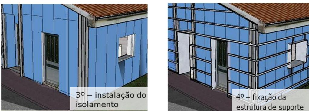
Figura 5.10 – Processo de montagem do sistema de reabilitação – SFV
