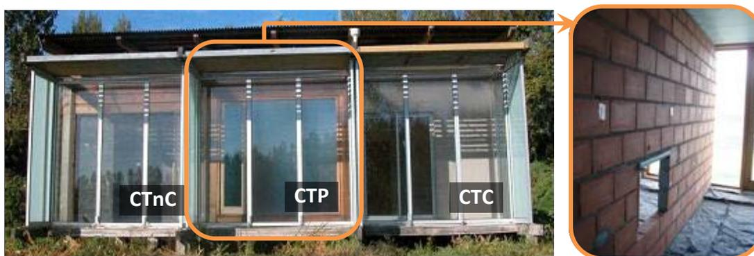
Figura 7.7 – Fachada Sul das células de teste e pormenor do interior da célula de teste Passys com parede para teste
