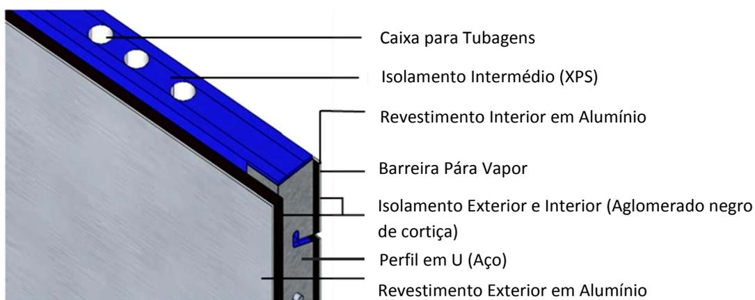
Figura 5.12 – Composição base do Módulo de Reabilitação Prefabricado
