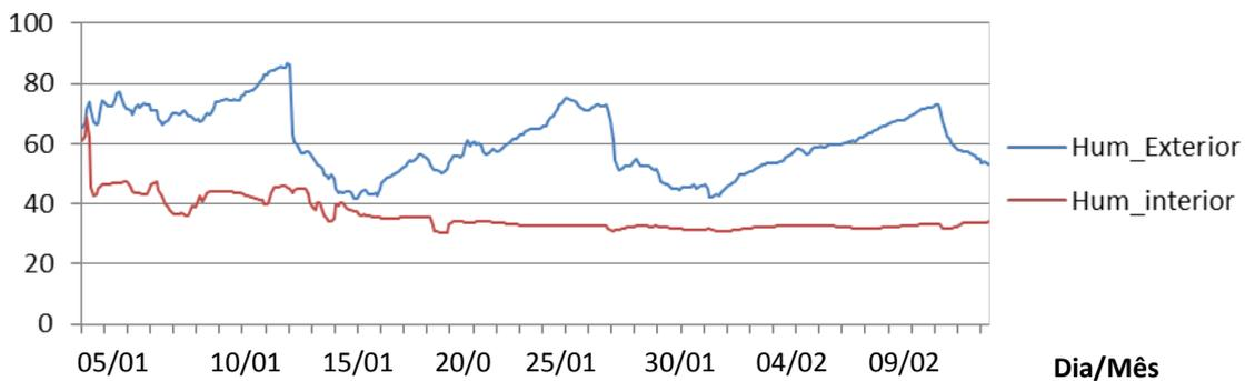
Figura AII.24 – Humidade relativa medida no edifício CS10.
