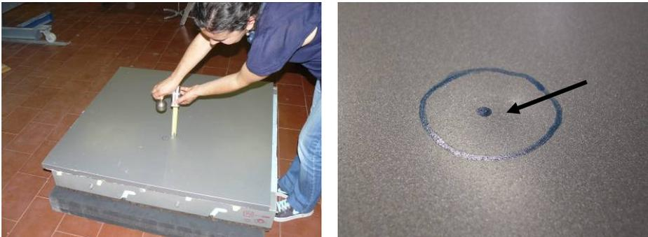
Figura 7.17 – Ensaio de impacto com esfera de aço de 0,5kg – altura de 0,20m
