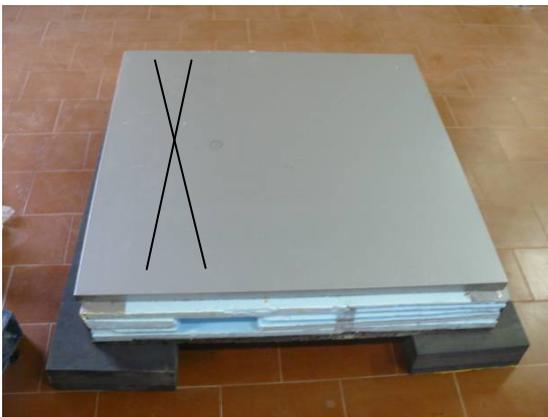
Figura 7.15 – Definição do ponto de impacto no painel
