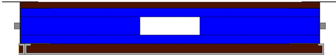
Figura 6.9 – Vista de topo do módulo com orifício para passagem de tubagens
