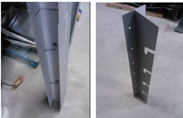
Figura 7.1 - Perfis-U em aço (esq.) e estrutura de suporte (dir.)
