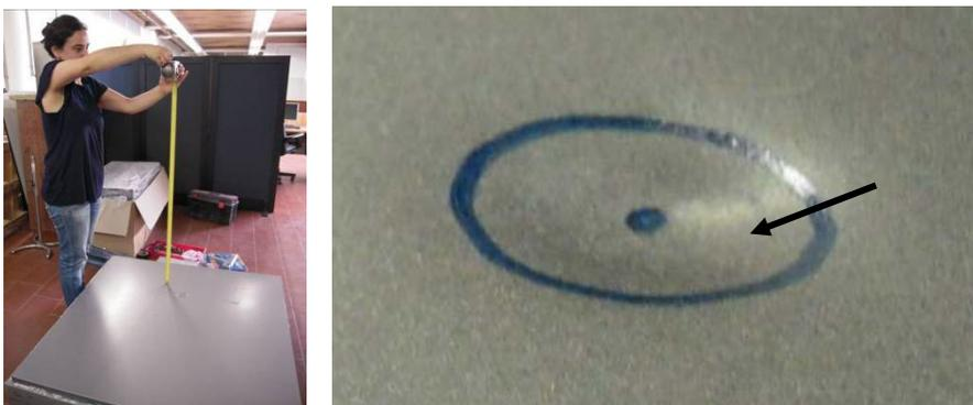
Figura 7.16 – Ensaio de impacto com esfera de aço de 1kg e respetiva deformação
