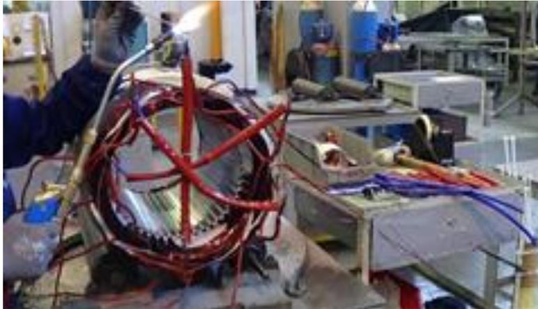
**Figura 40 - Ligação do Estator**
