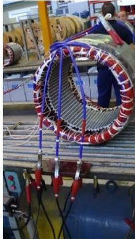
Figura 42 - Acabamento e ensaio do estator
