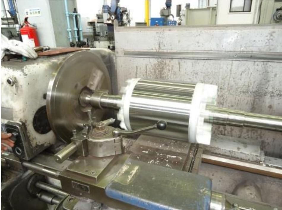
**Figura 36 - Operação de tornear o rotor**
