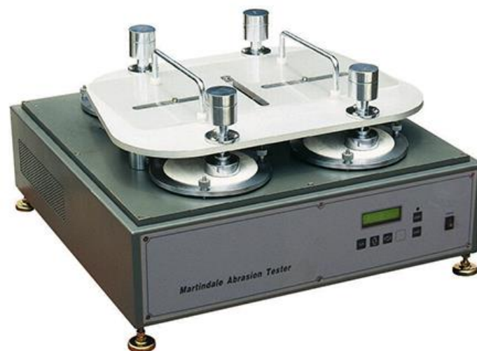
Figura 36 - Exemplo de um equipamento de teste de abrasão [16]
