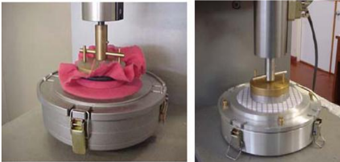
Figura 22- As duas vertentes de ensaios: tecido-tecido (esquerda) e tecido-metal (direita) (adaptado de [15])
