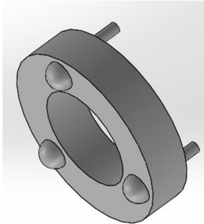
Figura 39 - Modelo possível do novo corpo padrão com pés esféricos
