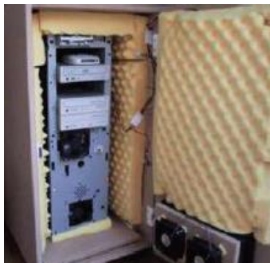
Figura 2.1 - Suporte de isolamento anti vibrátil de um processador, separado por espuma [3].
